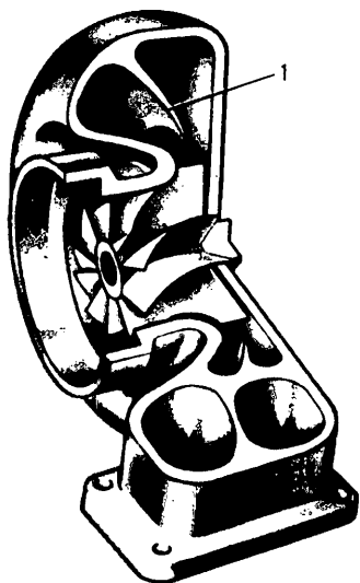
Рис. 73. Преобразователь импульсов, выполненный в корпусе центробежной турбины
