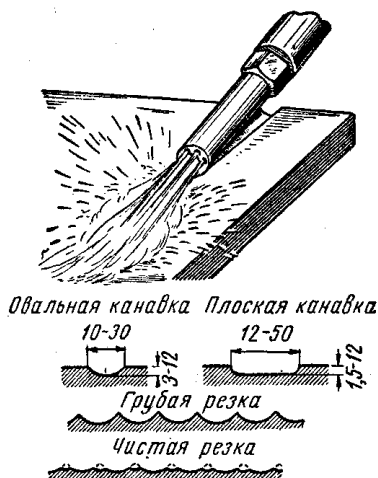
Рис. 13.14. Схема поверхностной кислородной резки и формы выплавляемых канавок
