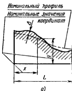
Рис. 8.6. Отклонение формы заданного профиля
