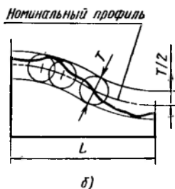
Рис. 8.6. Отклонение формы заданного профиля
