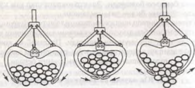
26-расм. Ёғоч ғўлаларни кўтаришда қўлланиладиган қисқичлар.
