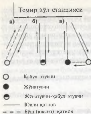
23-расм. Контейнерлар ташиш схемаси
