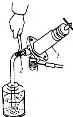
11.3- расм. Нексия автомобилнинг илашиш муфтаси юритмасидан ҳавони чиқариш.
