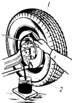
12.6- расм. Тормоз тизимидан ҳавони чиқариш.
