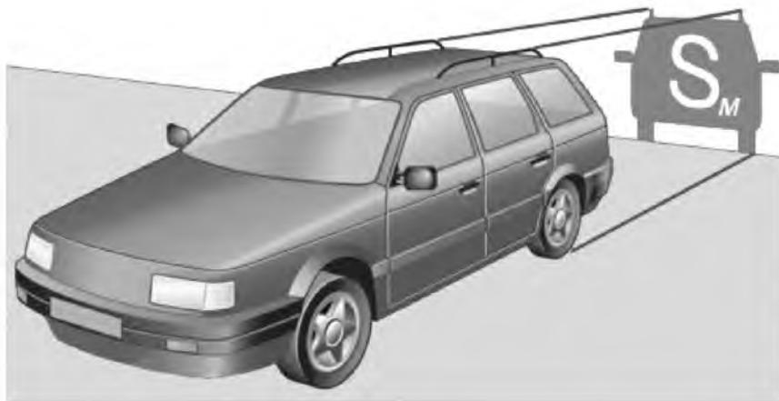
Рисунок 3.2.3 Определение миделевого сечения автомобиля
