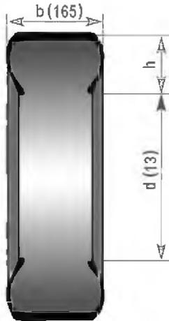
Рисунок 1.2.1 Размеры автомобильной шины (165/70 R13 79T)
