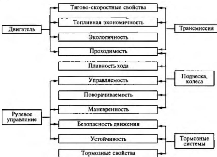
Рисунок 3.1.1 Связь эксплуатационных свойств с системами и механизмами автомобиля
