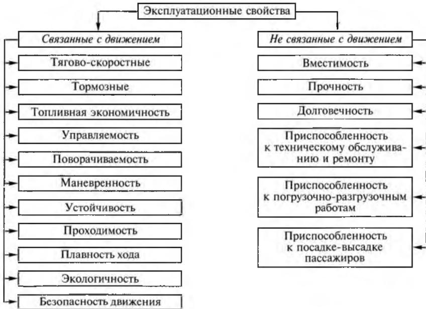
*Эксплуатационные свойства автомобиля*
