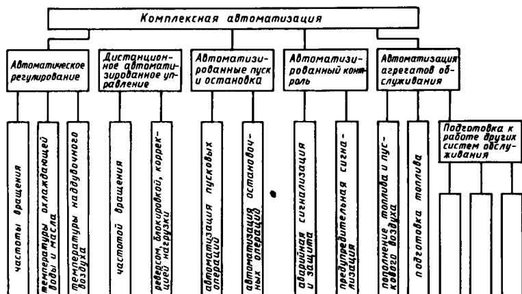
Рис. 14.1. Структура системы комплексной автоматизации главного судового двигателя
