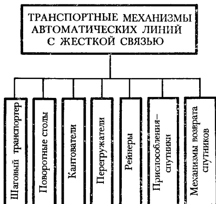
Рис. VI-2. Классификация транспортных механизмов линий с жесткой связью
