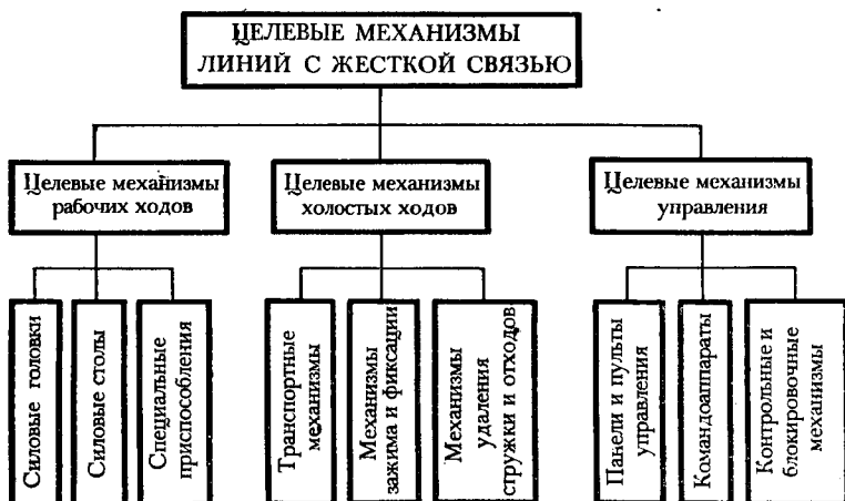
Рис. VI-1. Классификация целевых механизмов автоматической линии с жесткой связью
