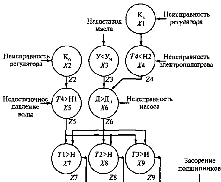
Рис. 3.42. Граф причинно-следственных связей системы смазки подшипников редуктора
