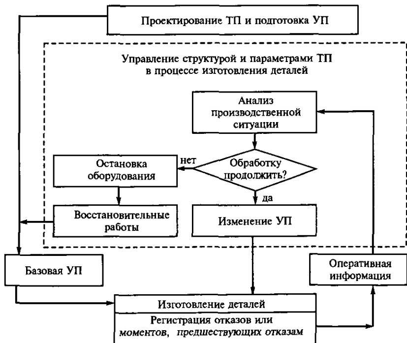
Рис. 6.14. Схема функционирования интегрированной системы проектирования ТП
