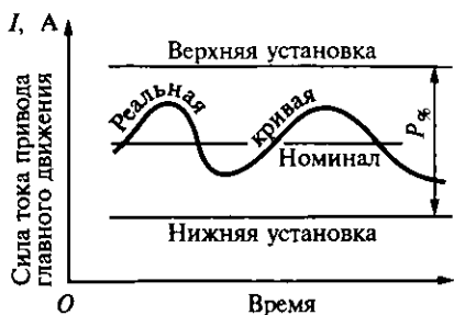
Рис. 3.48. Связь величины допустимого поля отклонения силы тока P_{\kappa} с пределами уставок
