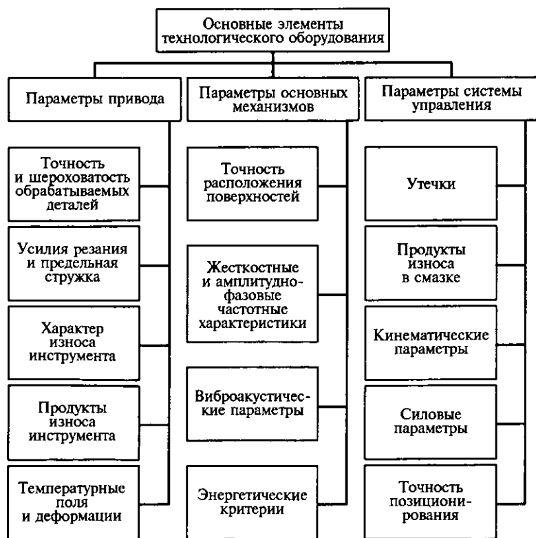
Рис. 3.43. Параметры диагностирования основных элементов металлообрабатывающего оборудования
