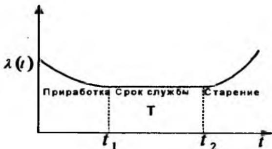
Рис.10.9. Зависимость интенсивности отказов приборов от времени.
