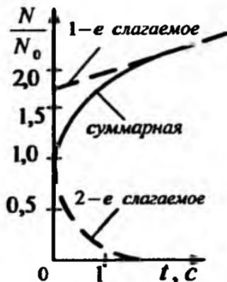
Рис. 13.7. Кривые разгона реактора при  $\rho > 0$  с учетом одной группы запаздывающих нейтронов
