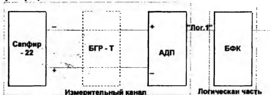
Рис.10.13. Схема формирования сигнала защиты по снижению давления
