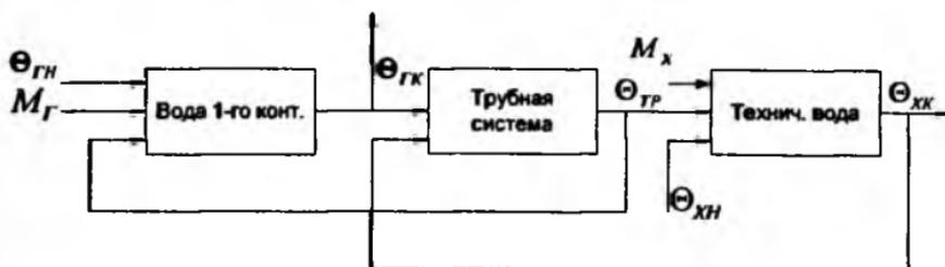
Рис. 9.8. Структурная схема модели ТО
