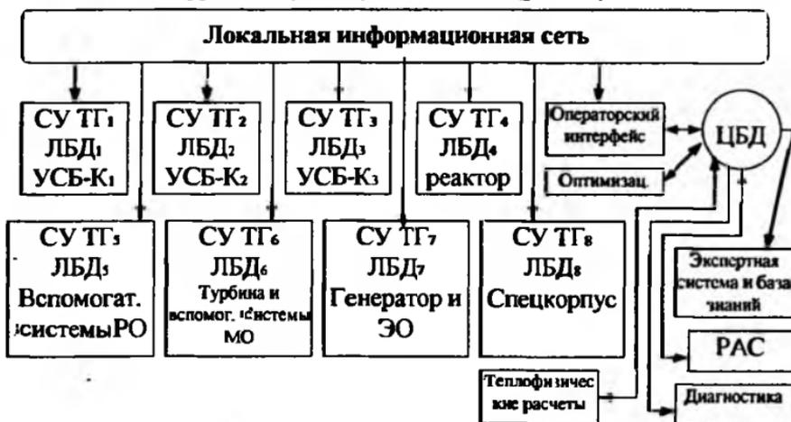
Рис. 1.4. Функциональная структура АСУ ТП
