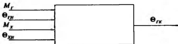
Рис. 9.7. Параметрическая схема ТО
