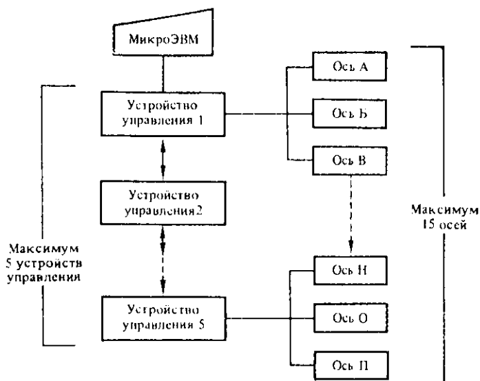
Рис. 7.7. Блочная структура схемы управления по нескольким осям
