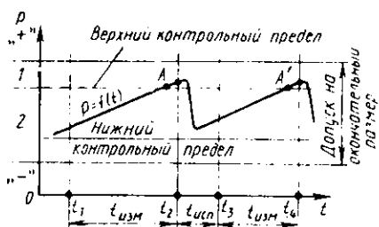
Рис. 11.8. Изменение контролируемого параметра в процессе автоматической подналадки
