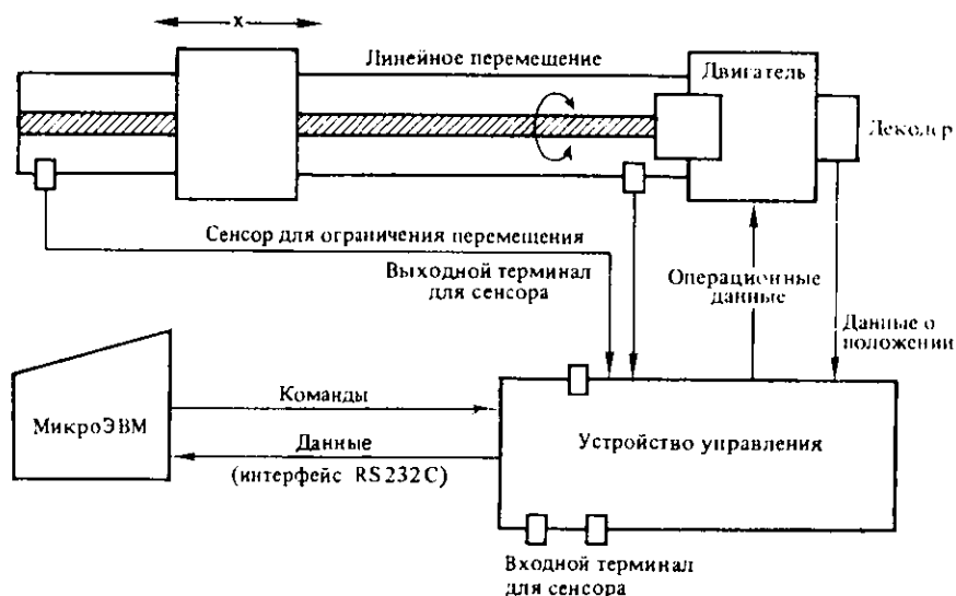
Рис. 7.6. Пример технического решения вопроса управления по одной оси перемещения
