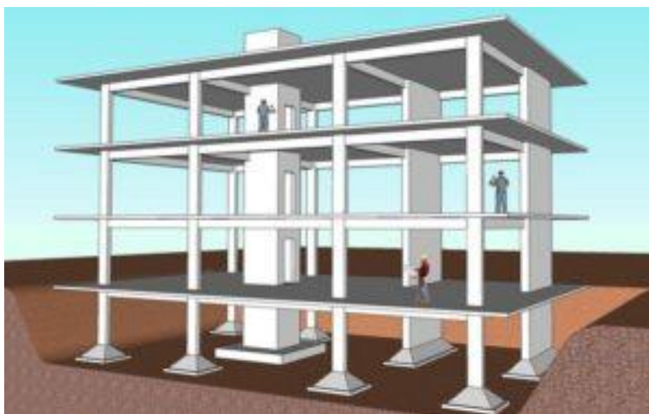
14.12-rasm. Bikir yadroli bino konstruksiyalarining tasviri. Bino o'rtasida tekis devorli bikirlik yadrosi joylashtirilgan
