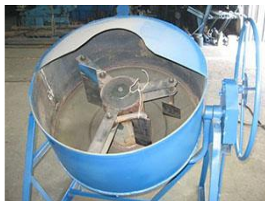
15.26-rasm. Beton komponentlarini majburan aralashtirishga mo'ljallangan siklik ish rejimiga ega bo'lgan betonqorgichlar.
