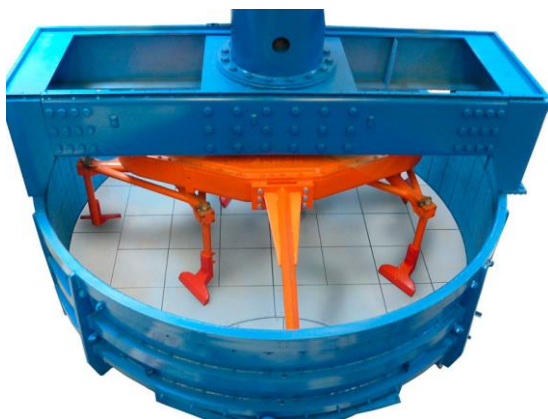
15.26-rasm. Beton komponentlarini majburan aralashtirishga mo'ljallangan siklik ish rejimiga ega bo'lgan betonqorgichlar.
