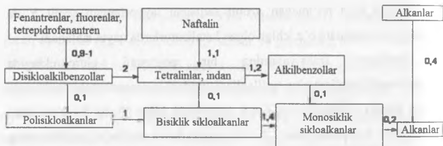
13.1– rasm. Uglevodorodlarning gidrokreking jarayonidagi o'zgarish sxemasi.
