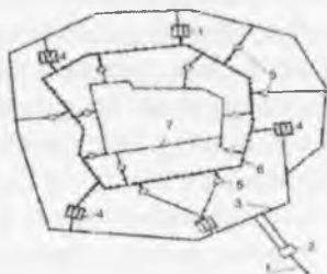
19.3-rasm. Uch bosqichli gaz taqsimlash chizmasi: 1 - magistral gaz quvuri; 2 - gaz rostdash stansiyasi (GRS); 3 - yuqori bosim gaz quvuri; 4 - gazgolder stansiyalari; 5 - GRPlar; 6 - o'rta bosim gaz quvuri; 7 - past bosim iste'molchilariga tarmoqlar.
