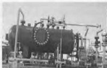
9.8-rasm. O'lchagich-ajratkich sxemasi va umumiy ko'rinishi
