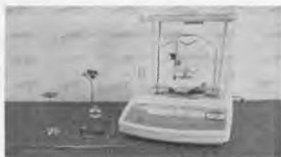
2.4-rasm. Hidrostatik tarozida tortish
