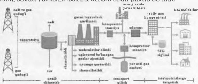
13.3-rasm. Gazlarni yig'ish va tayyorlashning sxematik ko'rinishi
