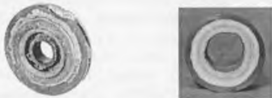
7.5-rasm. EMQN ishchi halqasida va quvurlarda tuz yotqiziqlari
