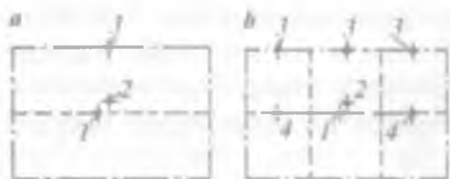
4.1- rasm. Shaxta maydonini gorizontlarga (a) va bloklarga (b) ajratish.
