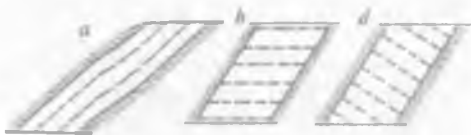
4.15- rasm. Qalin qatlamlarni tabaqalarga ajratish usullari.
