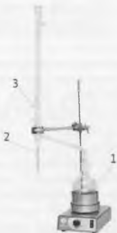
1-rasm. Neft mahsuloti tarkibidagi suvni aniqlash qurilmasi 1-kolba; 2-yig'gich-ajratkich; 3-sovutkich.
