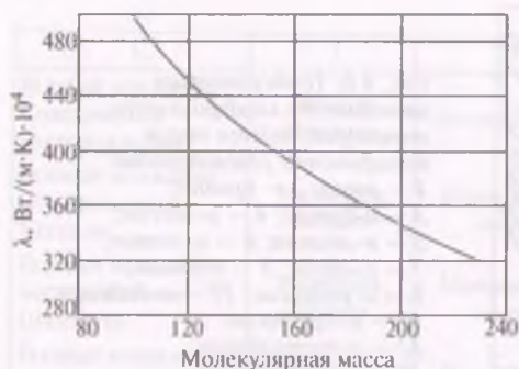
Рис. 4.8. Зависимость коэффициента теплопроводности n -парафинов от молекулярной массы при T = 523 \text{ K} [8]
