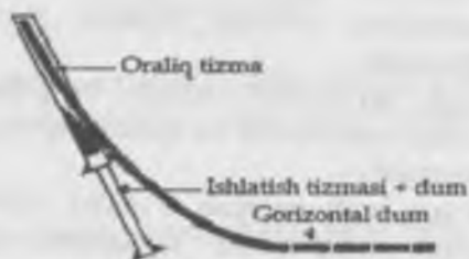
8.1-rasm. Derazani oraliq tizmasi chegarasida ochish
