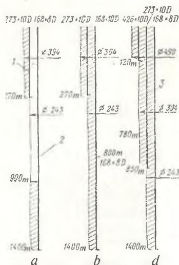
1-rasm. Quduqlar konstruk- siyasining sxemasi (o'lchamlar taxminan berilgan):
