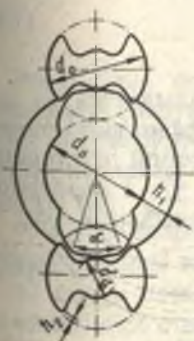
Рис. 1.25. Поперечное сечение трехвинтового насоса
