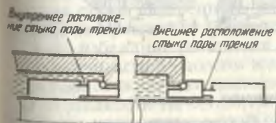
Рис. 3.5. Внутреннее и внешнее торцовые уплотнения
