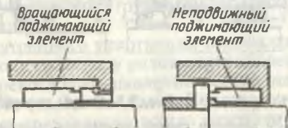
Рис. 3.6. Торцовые уплотнения с вращающимся и неподвижным элементами
