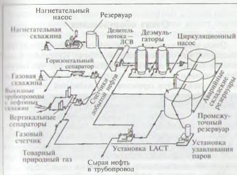
Рис. 11.7. Общая технологическая схема промысла
