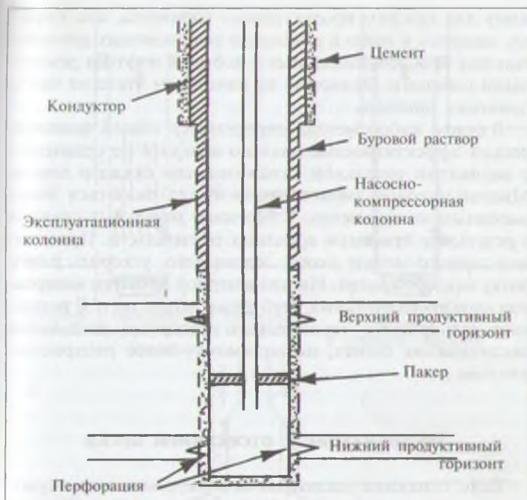
Рис. 7.3. Скважина, законченная в двух горизонтах. При таком методе для двух продуктивных пластов достаточно одного ствола скважины
