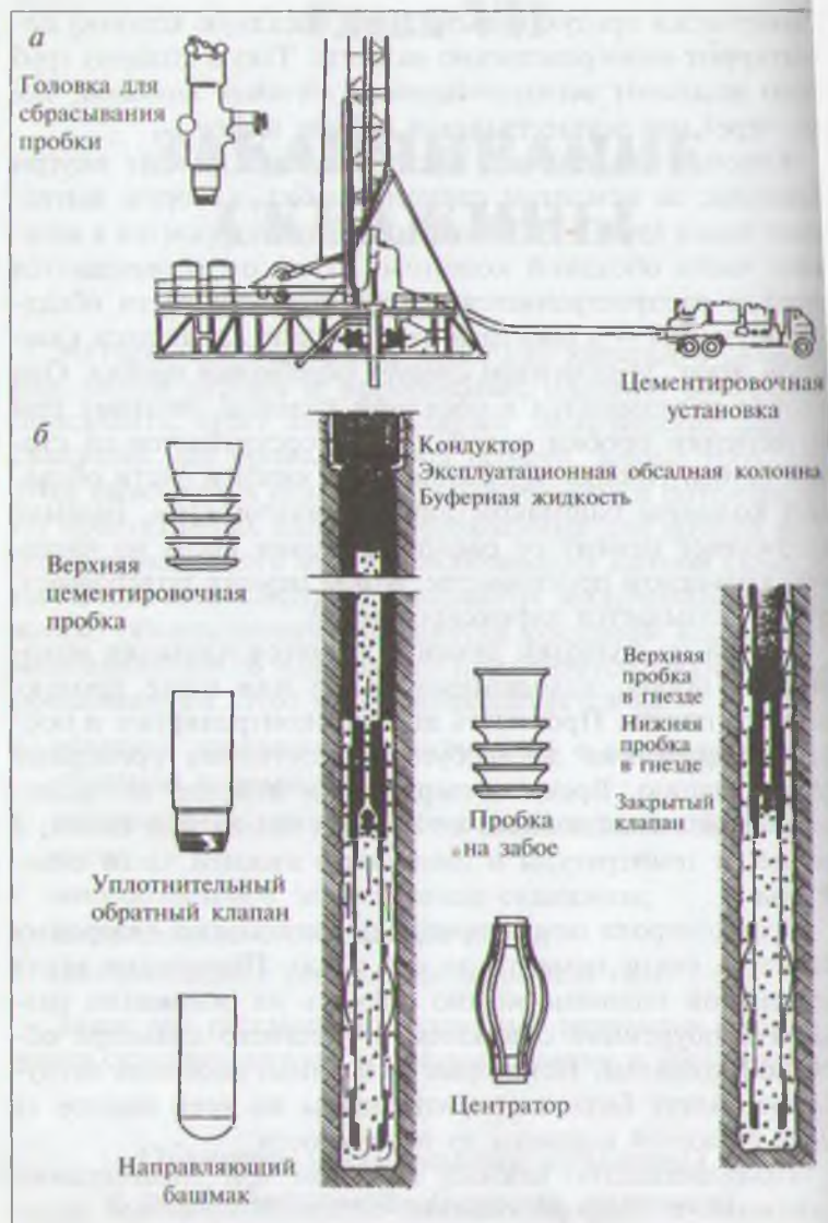
Рис. 7.1. Типовая схема цементирования после постановки обсадной колонны: а — цемент закачивают в скважину; б — эта операция закончена и цемент оставлен для затвердевания (составитель Halliburton)
