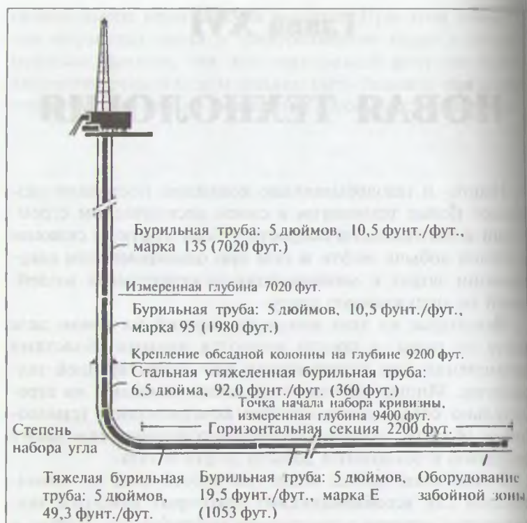
Рис. 16.1. Типовая горизонтальная скважина (вид на бурильную колонну)
