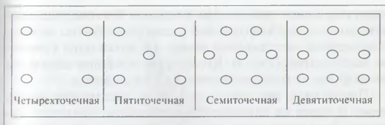
Рис. 4.4. Некоторые типовые схемы размещения скважин
