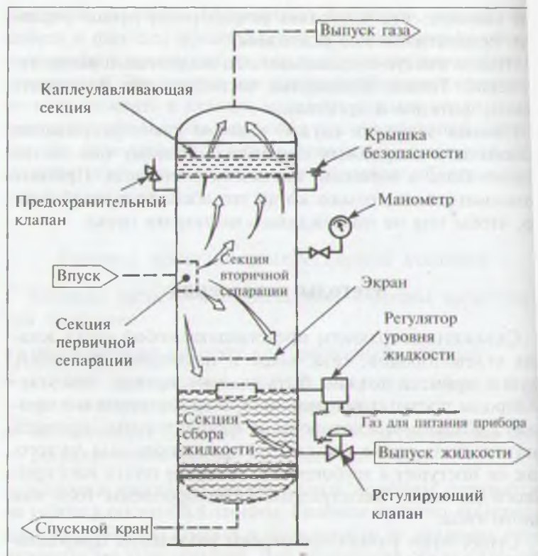
Рис. 11.3. Вертикальный двухфазный газосепаратор
