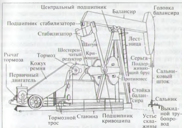
Рис. 10.16. Современный станок-качалка
