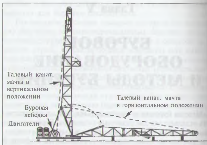
Рис. 5.1. Складная консольная вышка, используемая в установках для роторного бурения
