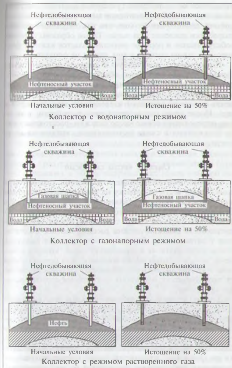
Рис. 4.2. Три варианта вытеснения нефти из пласта
