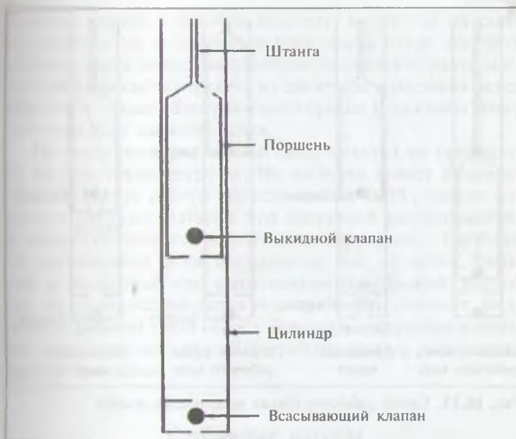
Рис. 10.12. Схематическое изображение простого штангового насоса
