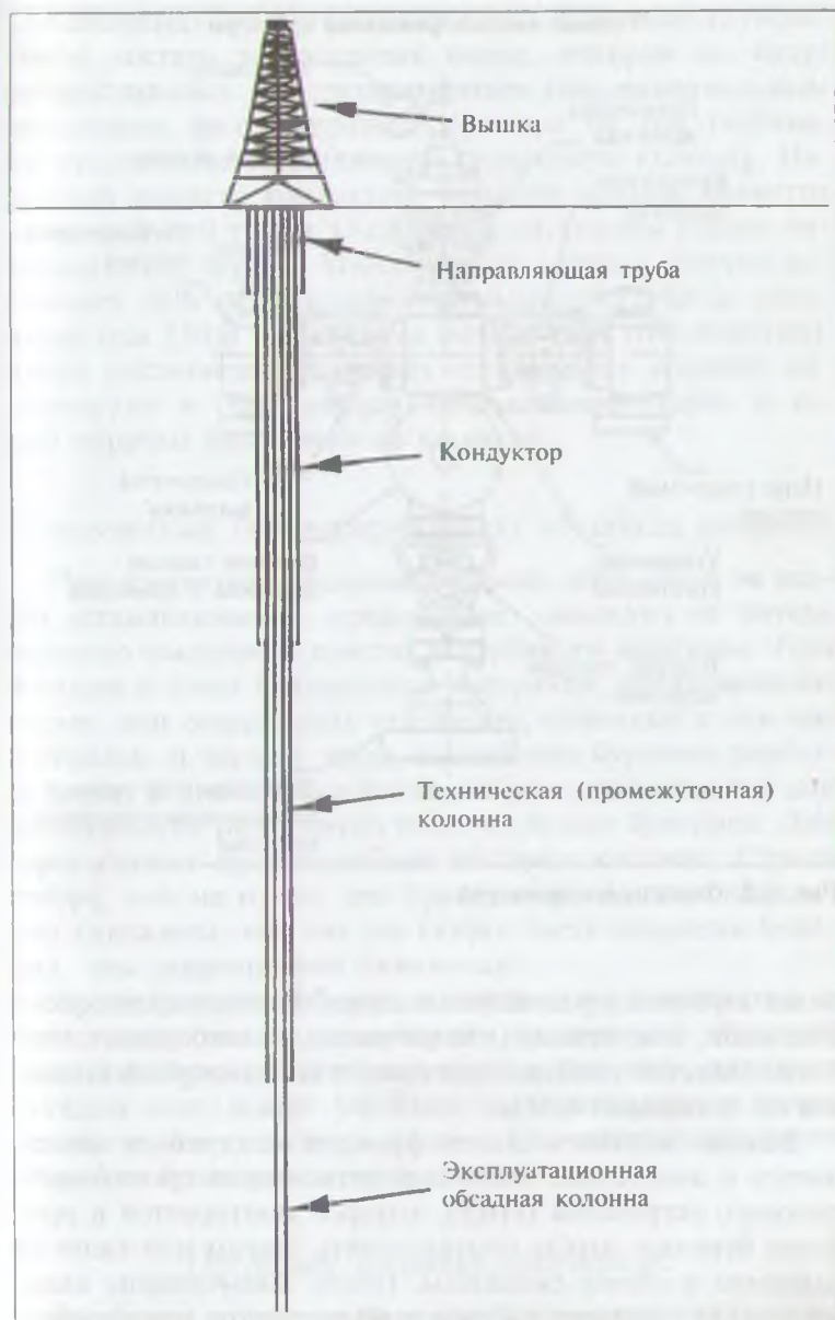
Рис. 8.1. Четыре класса обсадных труб
