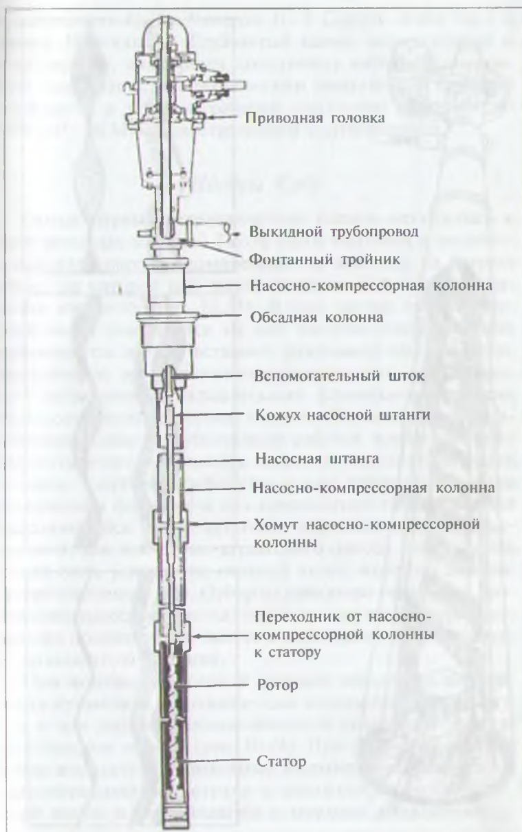
Рис. 10.21. Насос с поступательным движением полости
