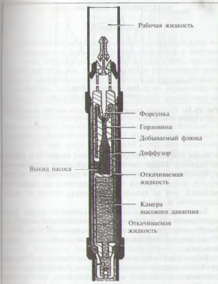
Рис. 10.30. Безобсадный гидравлический струйный насос
