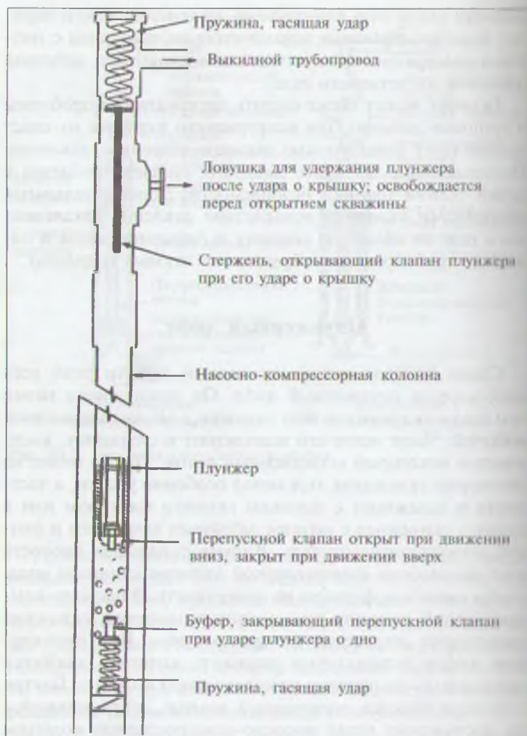
Рис. 10.9. Основные части плунжерного подъемника
