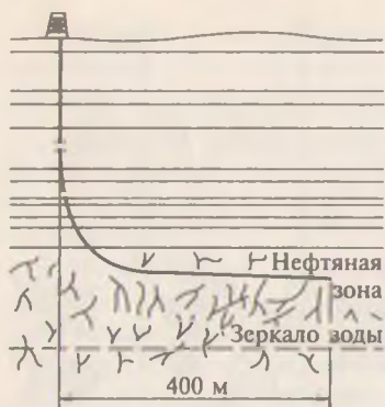
Рис. 8.17. Схема бурения горизонтальной скважины
