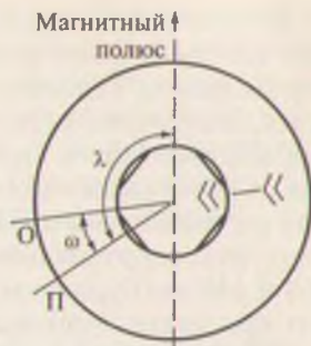
Рис. 8.12. Схема ориентирования отклонителя на роторе
