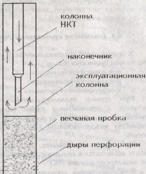
Рис.5. Схема размыва песчаной пробки при прямой промывке.
