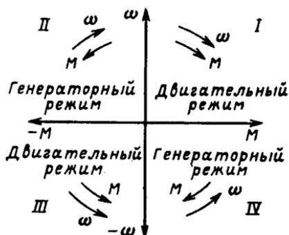
Рис. 3.3. Области режимов работы электропривода
