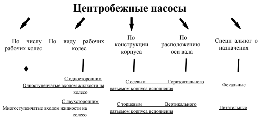
Рис. 2.196. Классификация центробежных насосов
