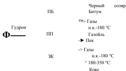
Рис. 9.3. Схемы переработки гудрона с получением нетопливных нефтепродуктов: ПБ — производство битума; ПП — производство пека; ЗК — замедленное коксование
