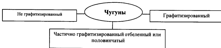
Рис. 2.224. Классификация чугуна по степени графитизации
