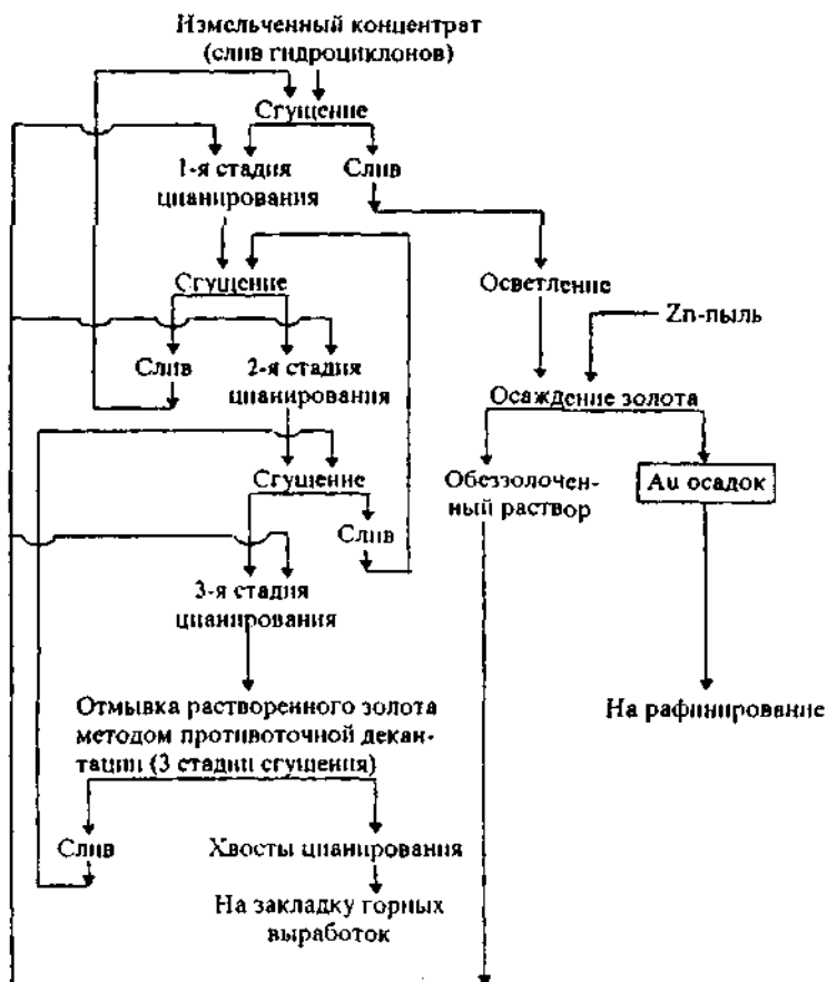
Рис. 8.4. Схема обогащения на фабрике «Итогон»
