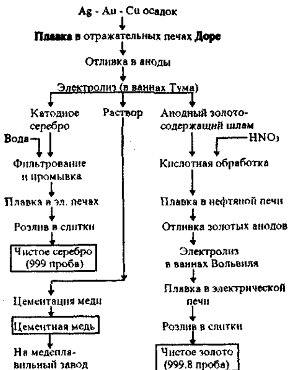
Рис. 8.9. Схема обогащения на фабрике «Реаль дель Монте»
