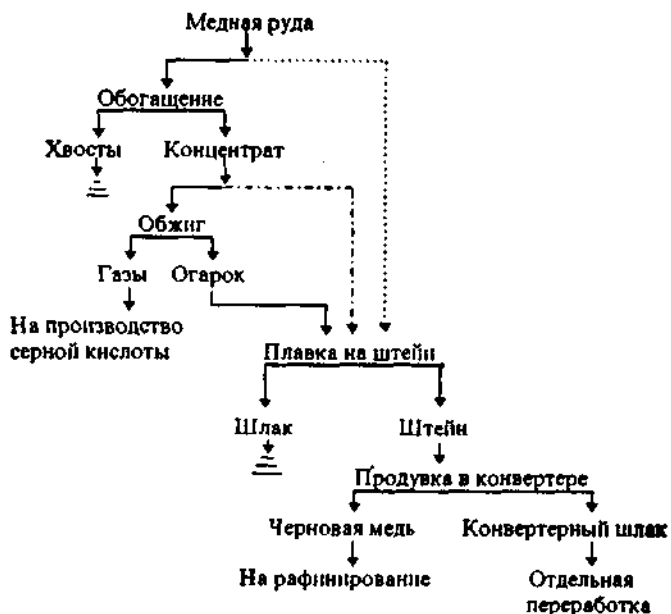
Рис. 10.1. Схема плавки медных золотосодержащих материалов
