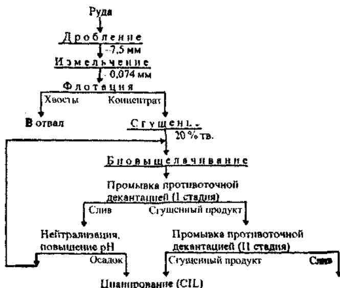
...с. 7.5. Схема обогащения на фабрике «Остин»
