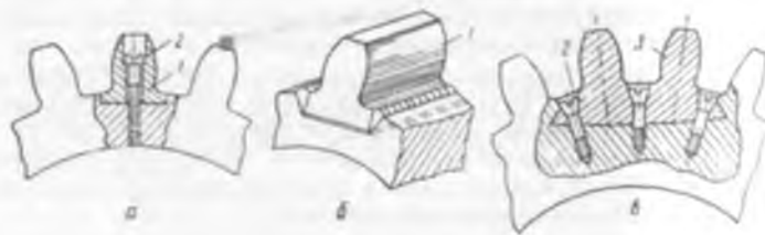
Рис. 4.10. Способы восстановления поломанных зубьев шестерен: а — на винтах; б — с помощью сварки; в — с помощью заклепок; г — вставной зуб. 1 — обод шестерни, 2 — вставная секция, 3 — крепежный элемент.
