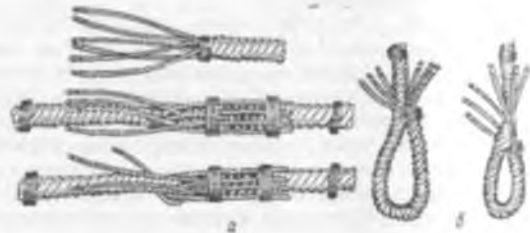
Рис. 6.1. Схемы сплетения тросов на прямом участке (а) и у петли (б)
