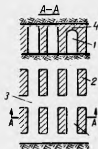
Рис. 67. Междукamerные целики при пологом залегании пласта
