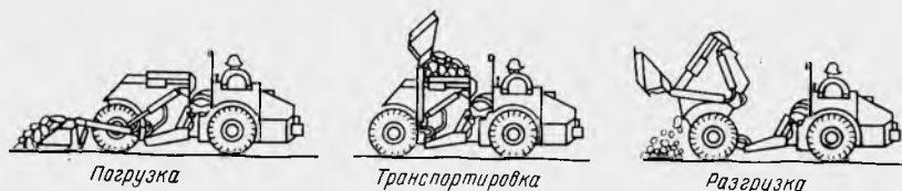
Рис. 56. Погрузочно-доставочная машина фирмы «Джой»
