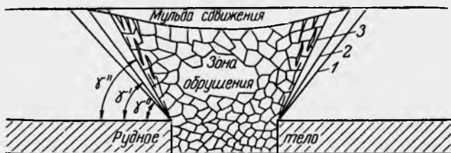
Рис. 9. Сдвигение горных пород при разработке: 1 — граница области сдвижения; 2 — граница зоны опасных сдвижений; 3 — граница зоны трещин (обрушения)
