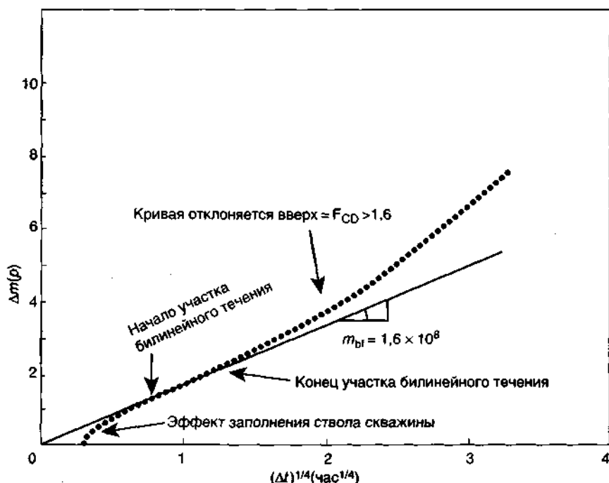
Рис. 1.73. График билинейного течения, данные взяты из примера 1.36 (по данным: Sabet, M. A. Well Test Analysis (Анализ результатов испытания скважин), 1991, Gulf Publishing Company)
