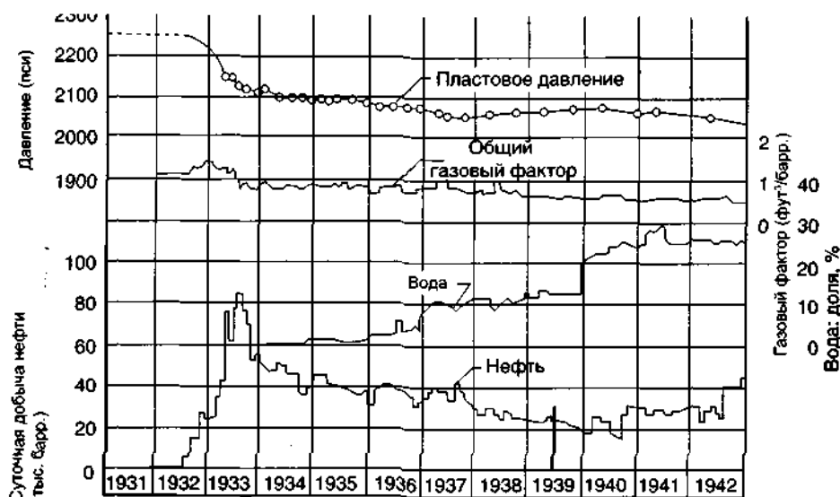
Рис. 4.10. Показатели разработки пласта водонапорным режимом (по: Clark, N.J., Elements of Petroleum Reservoirs (Элементы нефтяных пластов), SPE, 1969, данные предоставлены API)
