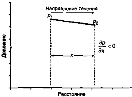
Рис. 1.9. Зависимость давления от расстояния в случае плоскопараллельной фильтрации
