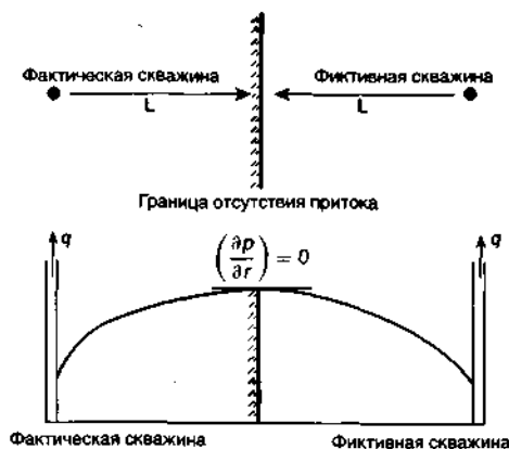
Рис. 1.94. Решение граничной задачи методом зеркальных отображений
