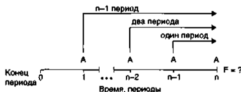
Рис. 6.5. Схема денежных потоков, используемая для вывода формулы начисления сложных процентов при платежах равными суммами
