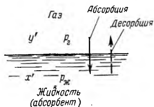
Рис. XV-1.* Схема обмена компонентами между газом и абсорбентом.
