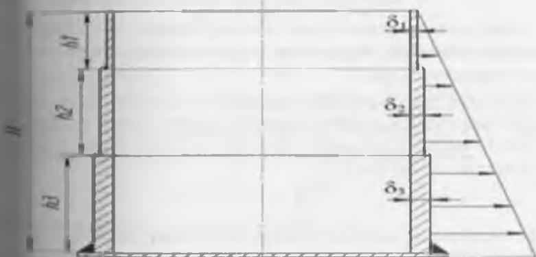
Рис. 10.7. Резервуар с переменной по высоте толщиной стенок
