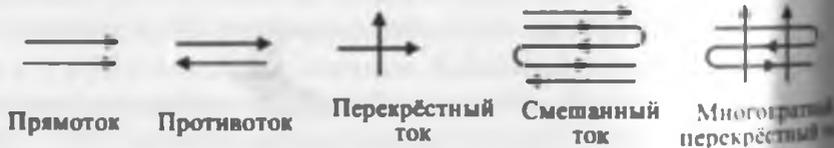
Рис. 9.5. Схемы движения теплоносителей
