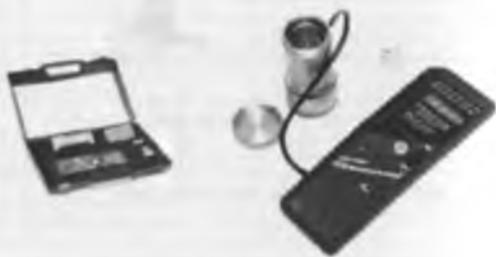
Рис. 10.11. Октанометр типа ПЭ-7300
