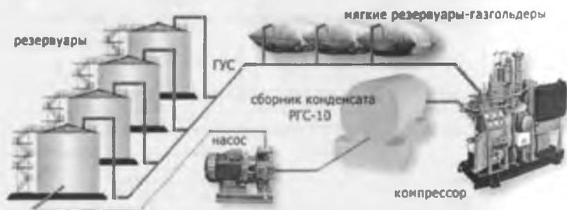
Рис. 14.5. Схема преобразования паровоздушной смеси в жидкости и ее возврат в резервуар
