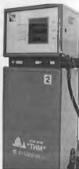
Рис. 13.7. Колонка для заправки автомобилей сжиженным газом
