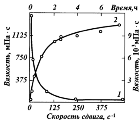
Рис. 5.21. Зависимость динамической вязкости кислого гудрона от скорости сдвига (1) и времени покоя (2)
