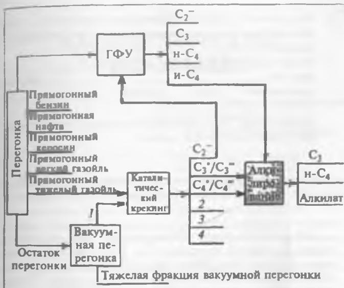
Рис. 8.3. Процессы нефтепереработки.
