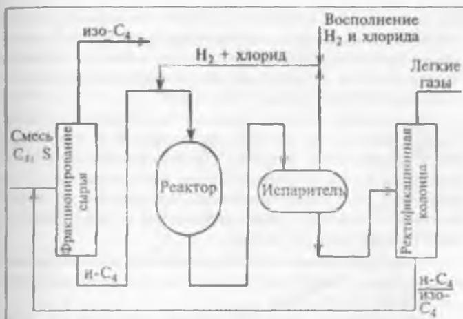
Рис. 16.1. Установка изомеризации бутана.
