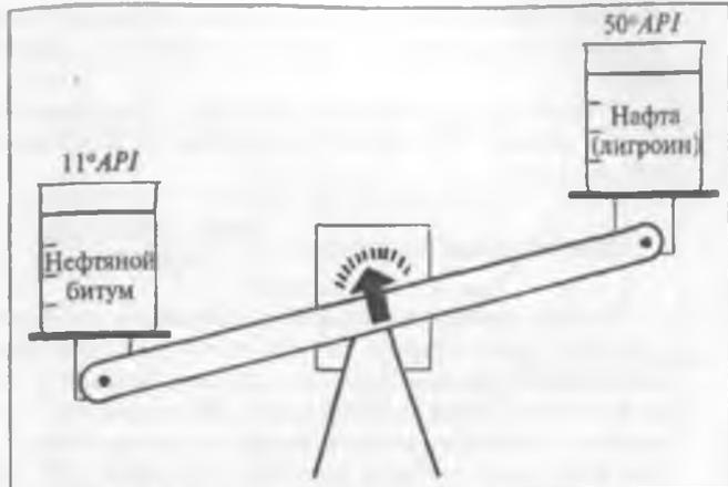
Рис. 2.6. Чем меньше плотность  $API$ , тем тяжелее жидкость.
