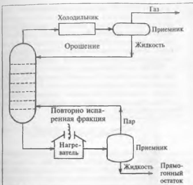
Рис. 3.8. Орошение и повторное испарение.
