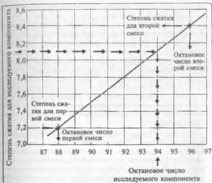
Рис. 12.3. График для определения октанового числа.
