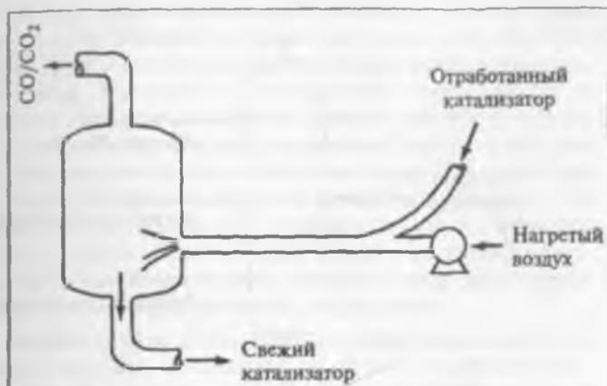
Рис. 6.2. Регенерация катализатора.
