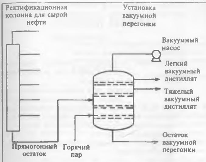
Рис. 4.3. Вакуумная перегонка.
