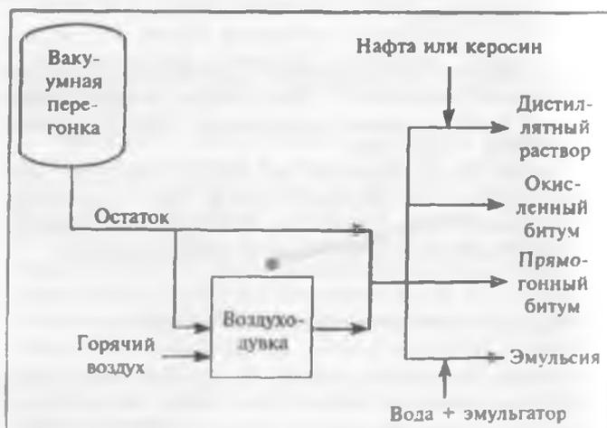
Рис. 14.2. Производство битумов разных видов.
