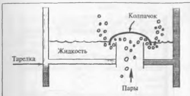
Рис. 3.6. Барботажные колпачки на тарелке ректификационной колонны
