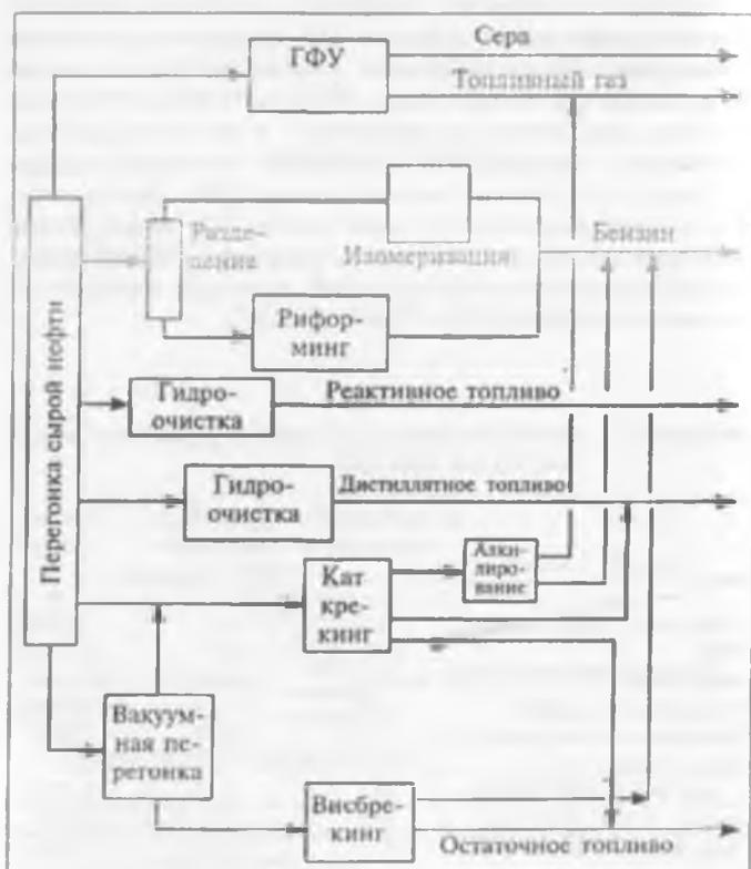
Рис. 19.2. Сложная нефтепереработка (бензиновый вариант)
