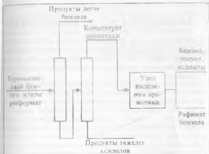
Рис. 17.2. Извлечение бензола, толуола и ксилолов
