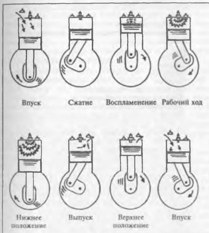
Рис. 12.1. Четырехтактный двигатель внутреннего сгорания.
