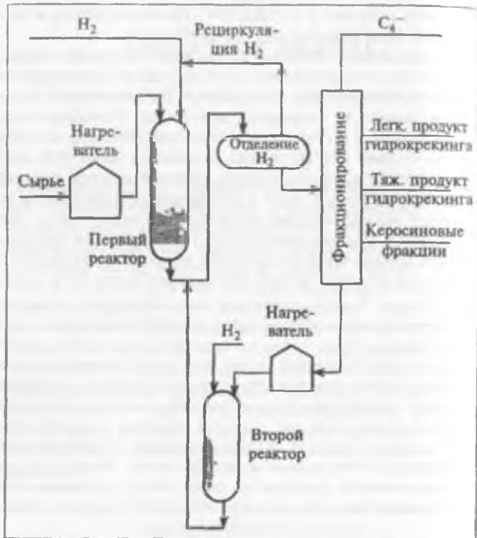
Рис. 11.1. Установка для двухступенчатого гидрокрекинга.
