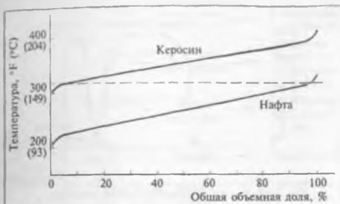
Рис. 3.9. Перекрывающиеся кривые разгонки.
