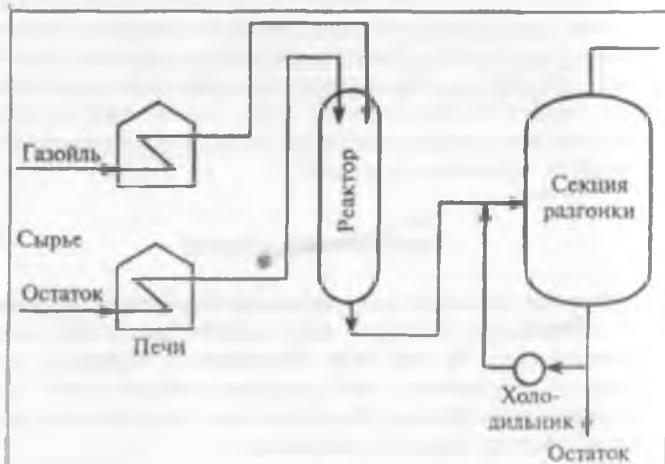
Рис. 10.1. Реакционный блок установки термического крекинга.
