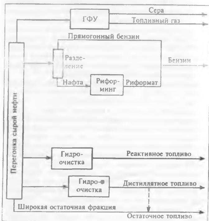
Рис. 19.1. Гидрооблагораживание легких фракций (простая нефтепереработка).
