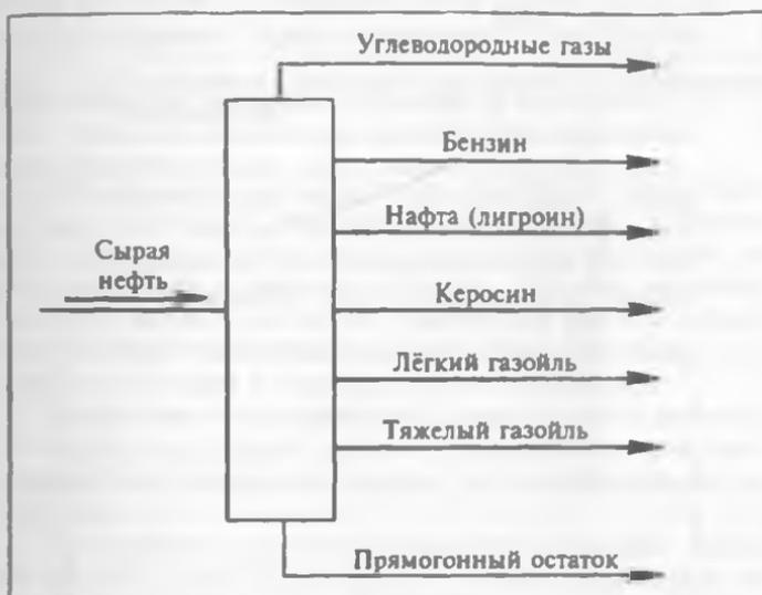
Рис. 3.3. Перегонка нефти.
