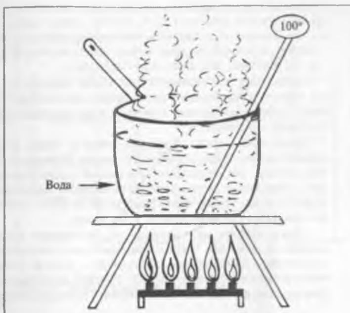
Рис. 2.1. Температура кипения воды 100°C (212°F).
