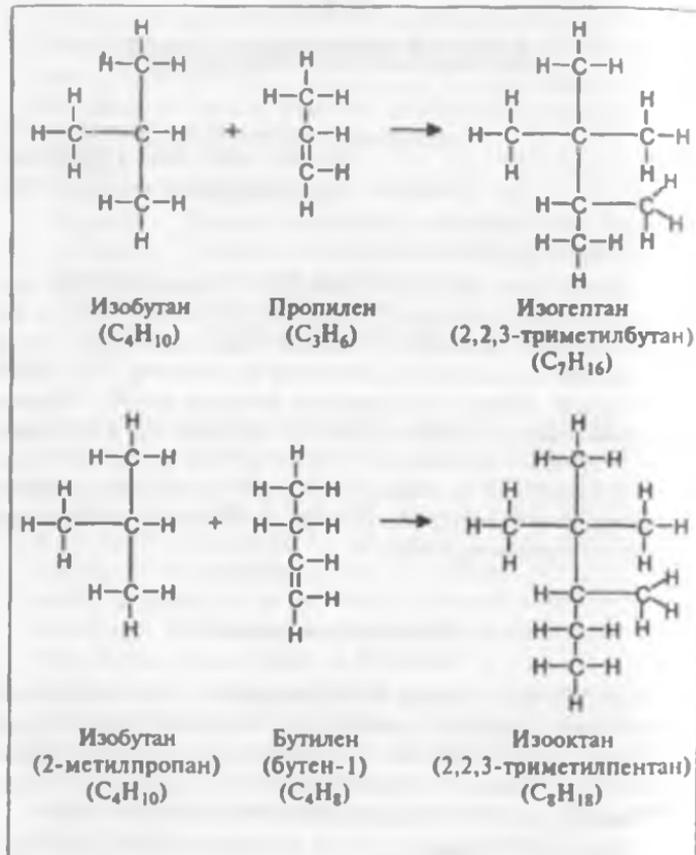
Рис. 8.1. Алкилирование пропилена и бутилена (бутена-1).
