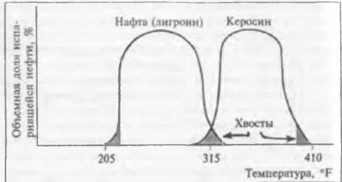
Рис. 3.10. Хвосты фракций на кривой разгонки.
