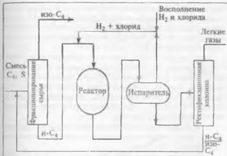
Рис. 16.1. Установка изомеризации бутана.
