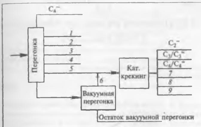
Рис. 6.5. Технологическая схема нефтепереработки:
