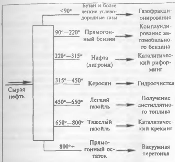
Рис. 3.11. Перегонка нефти и назначение продуктов.
