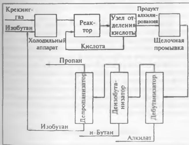
Рис. 8.2. Установка алкилирования.
