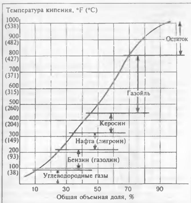
Рис. 2.4. Кривая разгонки сырой нефти и полученные фракции.
