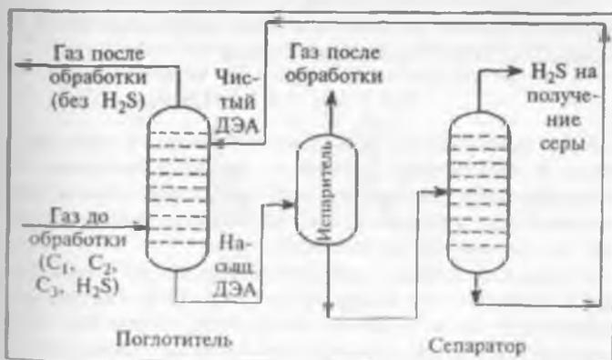
Рис. 15.3. Блок обработки диэтаноламином.
