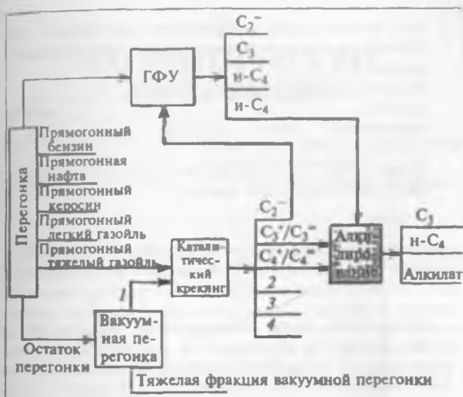
Рис. 8.3. Процессы нефтепереработки.
