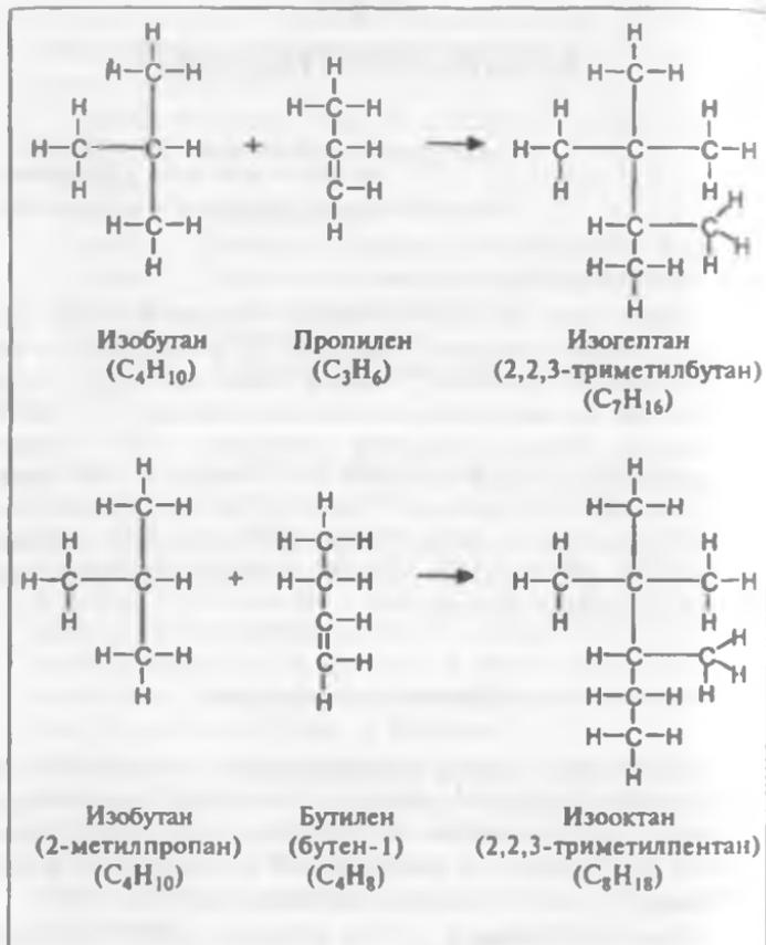
Рис. 8.1. Алкилирование пропилена и бутилена (бутена-1).
