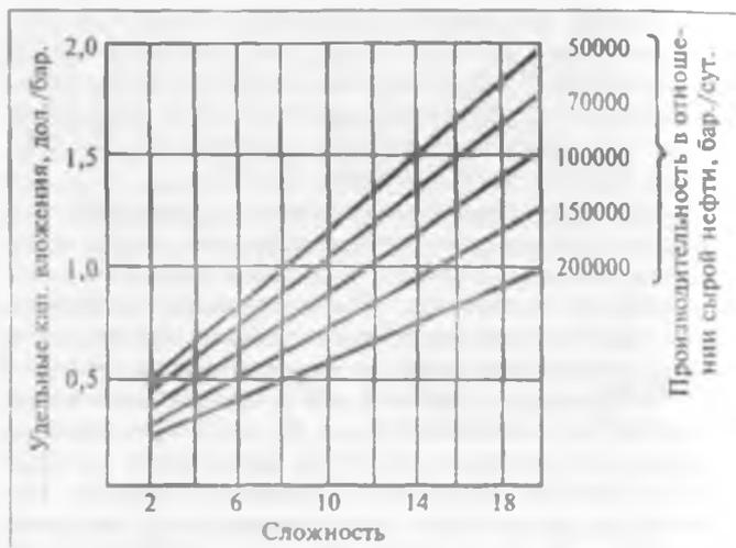
Рис. 19.3. Зависимость стоимости нефтеперерабатывающего завода от сложности.
