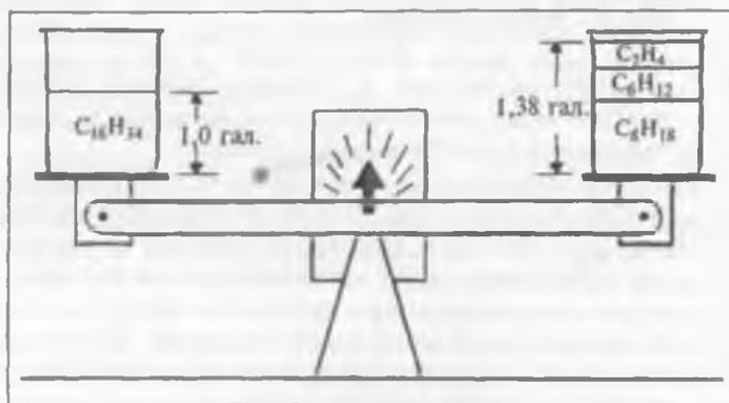
Рис. 4.2. Вес  $C_{16}H_{34}$  и компонентов крекинга одинаков.
