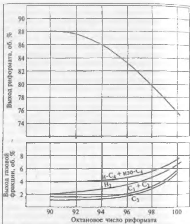
Рис. 9.3. Зависимость выхода риформата от его октанового числа.
