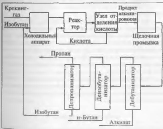
Рис. 8.2. Установка алкилирования.
