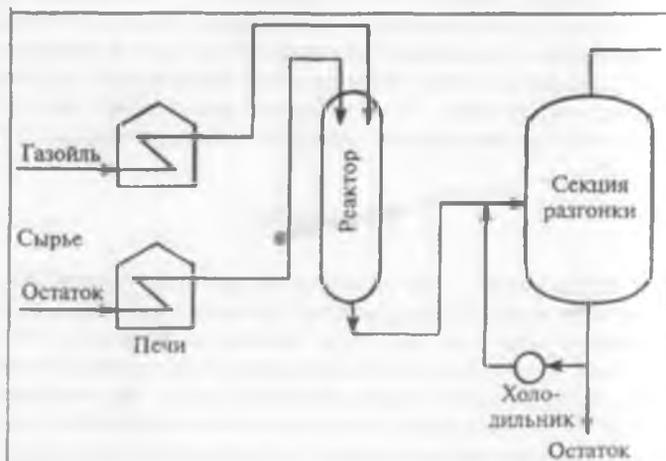
Рис. 10.1. Реакционный блок установки термического крекинга.
