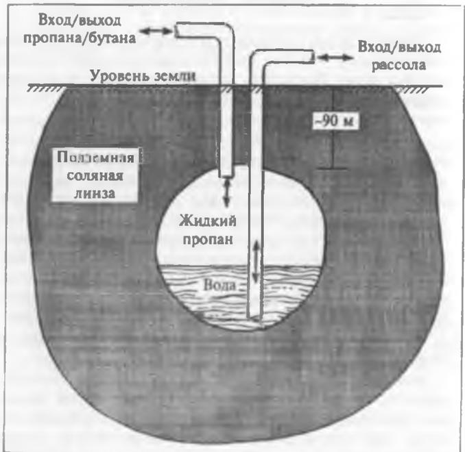
Рис. 7.6. Кувшин для подземного хранения пропана и бутана.
