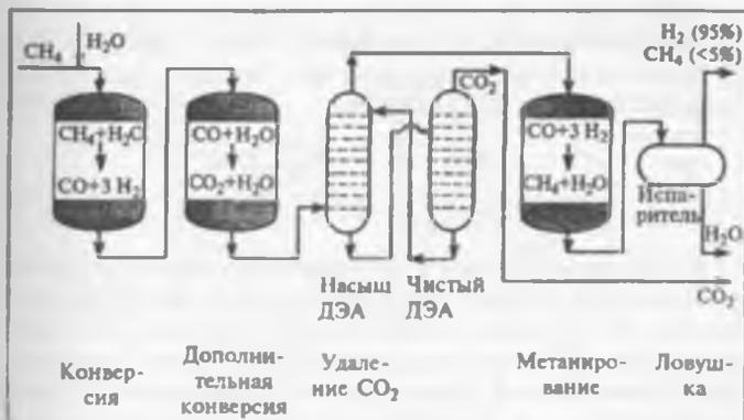
Рис. 15.2. Конверсия метана с водяным паром.
