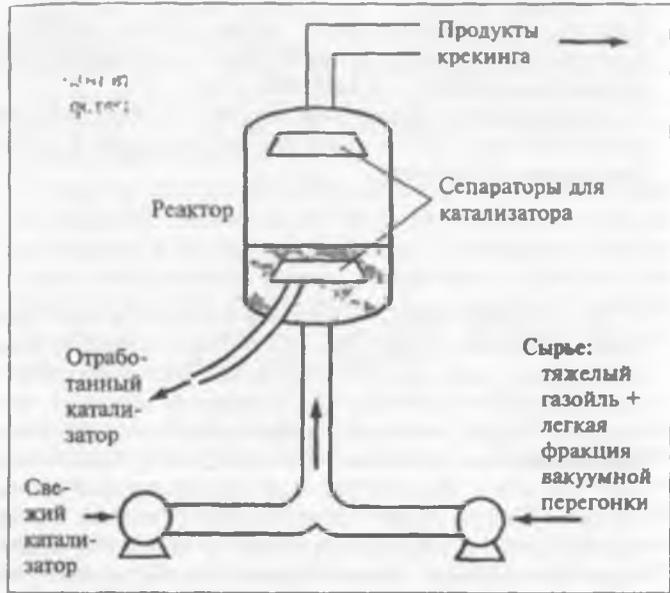
Рис. 6.1. Реакторный блок каталитического крекинга.
