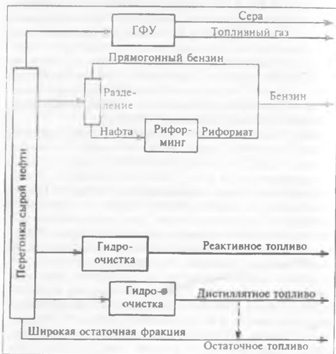
Рис. 19.1. Гидрооблагораживание легких фракций (простая нефтепереработка).
