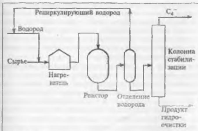
Рис. 15.1. Установка гидроочистки.
