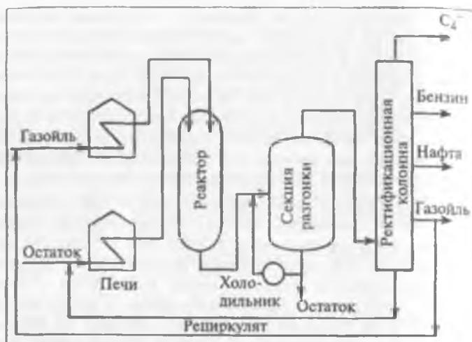
Рис. 10.2. Установка термического крекинга.
