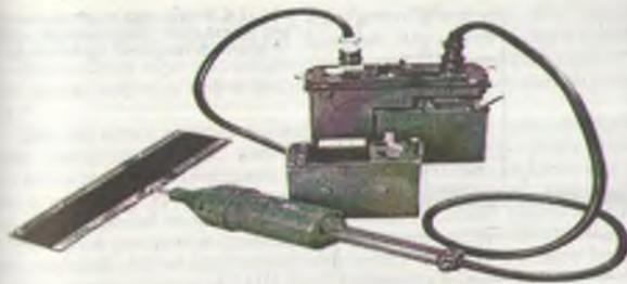
Рис. 8.3. Электроискровой дефектоскоп КРОНА-2И
