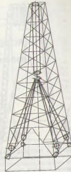
Рис. 13.1. Общая схема крепления талевого системы к основанию вышки
