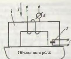
Рис. 7.13. Схема приставного П-образного электромагнита:
