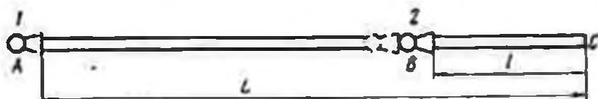
Рис. 7.3. Схема вентиляционной системы с рассредоточенной установкой двух вентиляторов местного проветривания
