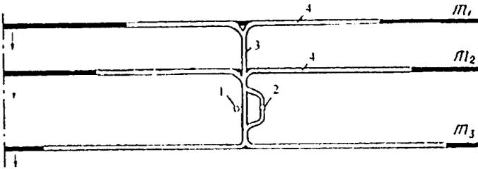
Рис. 6.14. Индивидуальная подготовка пластов в шахтном поле:
