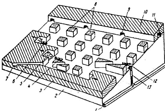
Рис. 6.55. Камерно-столбовая система разработки:
