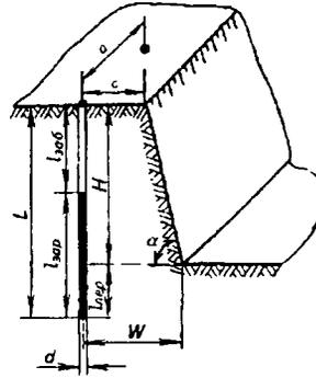
Рис. 5.12. Параметры взрывных скважин
