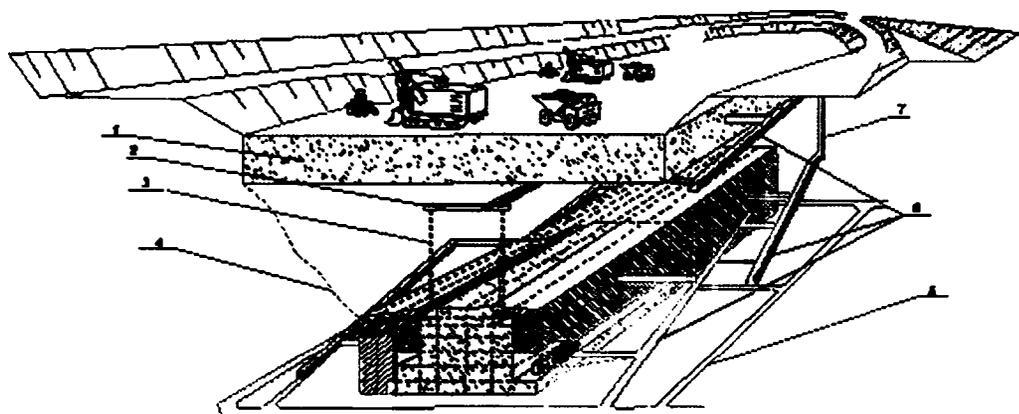
Рис. 7.8. Комбинированная разработка с обработкой горизонтальными слоями с
