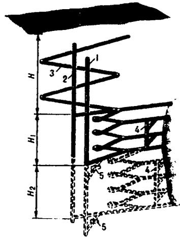
Рис. 6.33. Схема вскрытия и подготовки запасов крутопадающего рудного тела, залегающего на глубине до 600 м, концентрационным горизонтом при поэтапной разработке:
