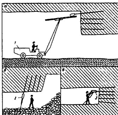
Рис. 6.47. Схемы отбойки руды горизонтальными (а и в) и восходящими (б) шпурами (а, б — отбойка на две свободные поверхности, в — на одну):
