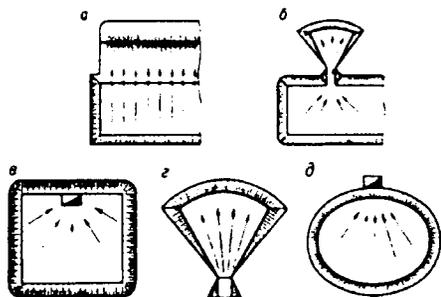
Рис. 5.26. Направления заездов бульдозеров (показаны стрелками);
