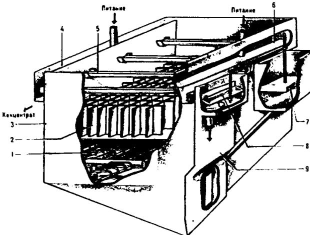
Рис. 12.8. Колонная флотационная машина:
