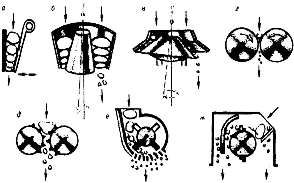
Рис. 12.1. Принципиальные схемы дробилок:
