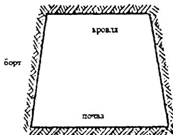
Рис. 3.8. Поперечное сечение горной выработки
