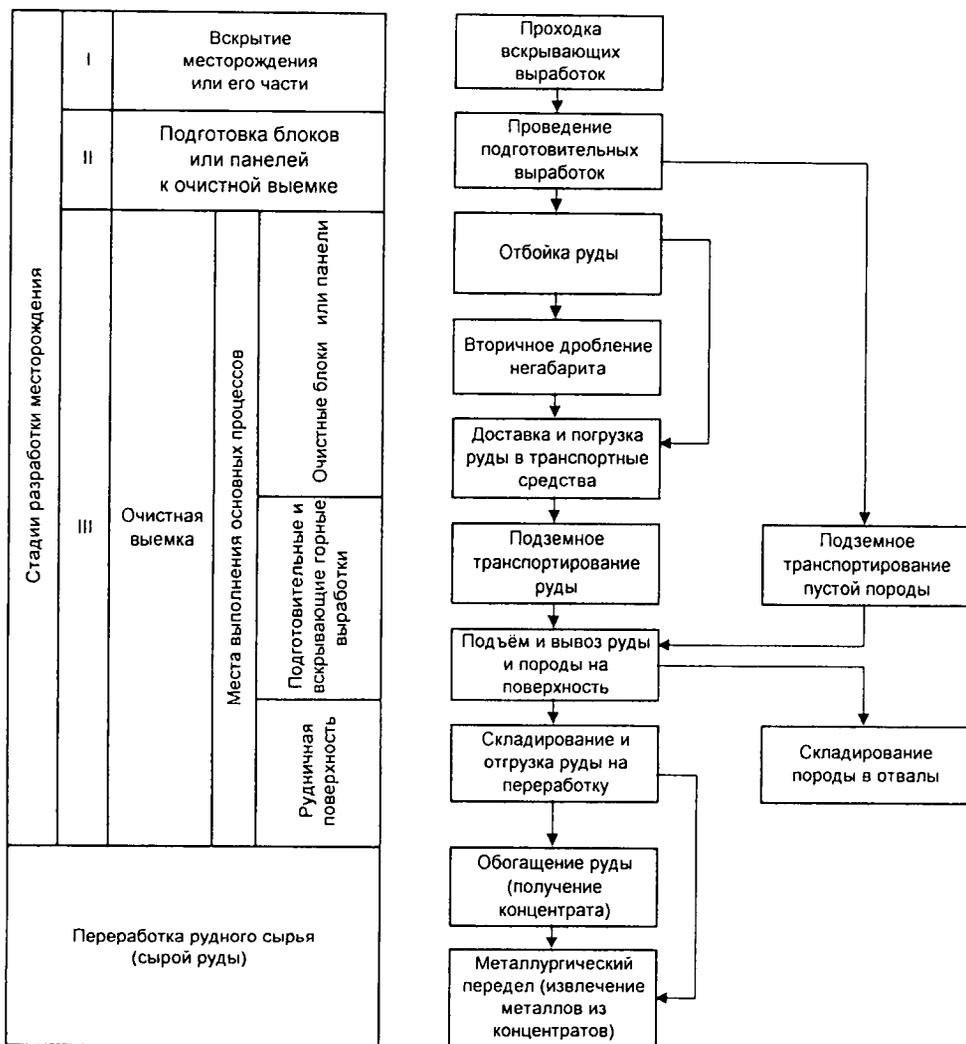
Рис. 6.44. Технологическая схема подземного рудника
