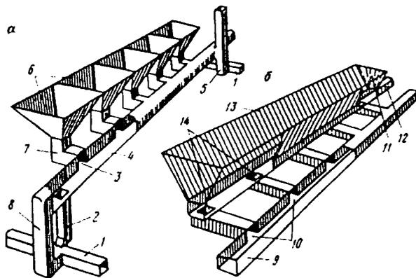
Рис. 6.48. Схемы оснований блоков в виде воронок (а) и траншеи (б) при донном выпуске руды:
