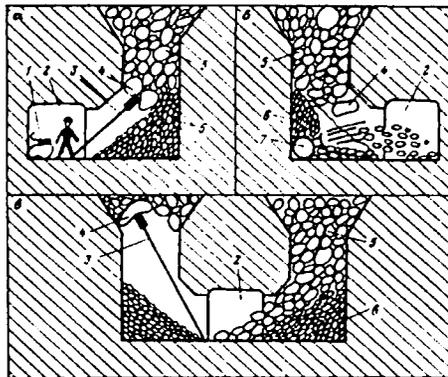
Рис. 6.49. Схемы ликвидации низкого (а), высокого (в) затворов с использованием фугасов и низкого затвора с применением пневмоимпульсных устройств (б):
