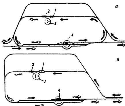
Рис. 6.38. Круговой (а) и петлевой (б) околоствольные дворы (черными и синими стрелками показано перемещение соответственно груженых и порожних вагонеток):
