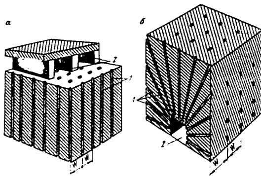
Рис. 6.46. Схемы параллельного (а) и веерного (б) расположения взрывных скважин при отбойке руды:
