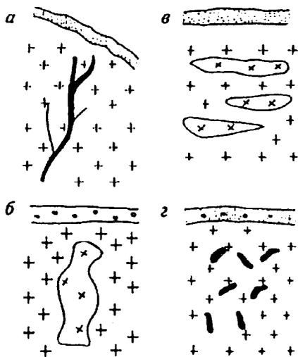
Рис. 3.3. Формы залегания рудных тел:
