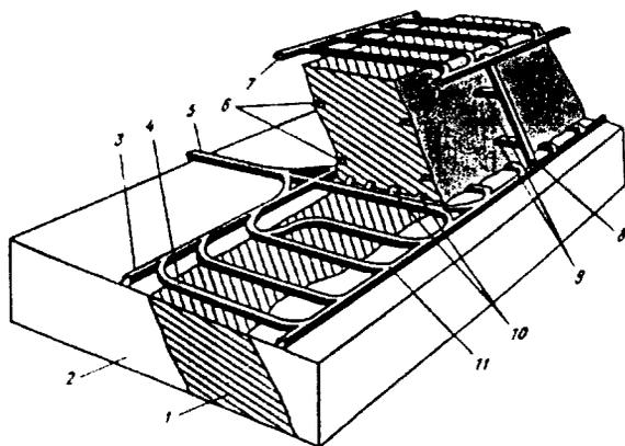
Рис. 6.45. Схема комбинированной подготовки рудной залежи
