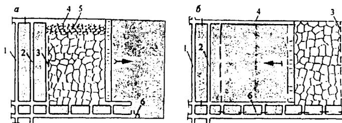
Рис. 6.4. Схемы прямого (а) и обратного (б) порядка отработки крыла шахтного поля:
