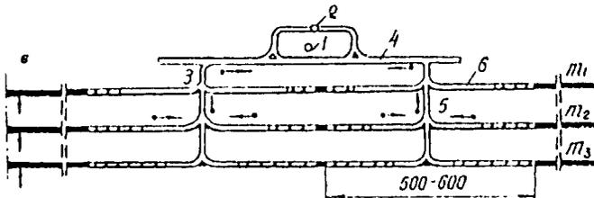
Рис. 6.15. Групповая подготовка с составкой на двусторонний (в) промквершлаг:
