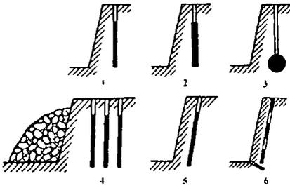
Рис. 5.11. Основные методы взрывного разрушения горных пород на открытых горных работах:
