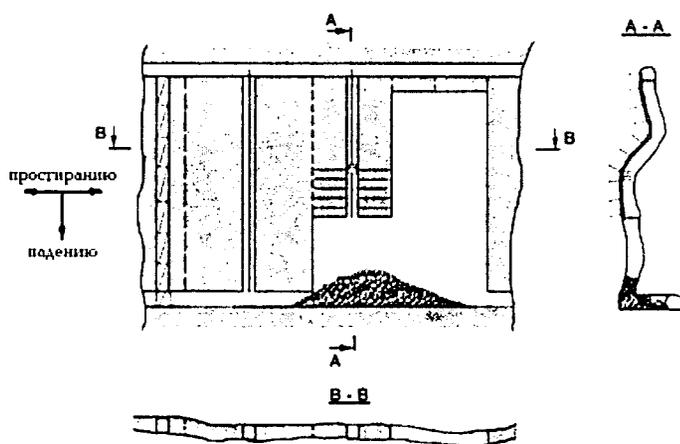
Рис. 6.78. Система с открытым очистным пространством и выемкой руды прирезками по простиранию из вертикальных буровых выработок
