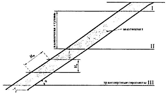
Рис. 6.2. Основные элементы структуры шахтного поля
