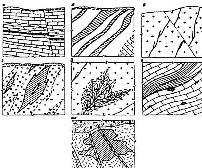
Рис. 3.1. Формы рудных тел (вертикальные, поперечные разрезы):
