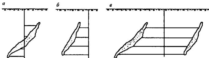
Рис. 6.43. Независимое (а, б) и совместное (в) вскрытие рудных тел
