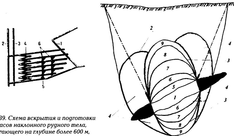
Рис. 6.39. Схема вскрытия и подготовки запасов наклонного рудного тела, залегающего на глубине более 600 м, концентрационным горизонтом:
