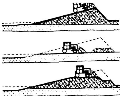
Рис. 5.27. Бульдозерная укладка торфов в отвал наклонными (а) и параллельными горизонтальными слоями в несколько стадий (б, в)
