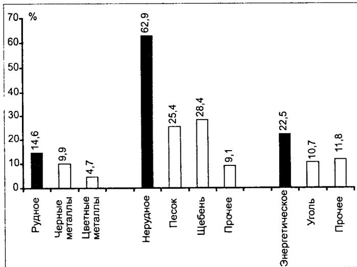
Рис. 1.3. Структура добычи из литосферы различных видов минерального и топливно-энергетического сырья
