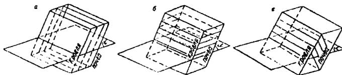
Рис. 6.30. Схемы деления мощного пласта на наклонные (а), горизонтальные (б) и поперечно-наклонные (в) слои
