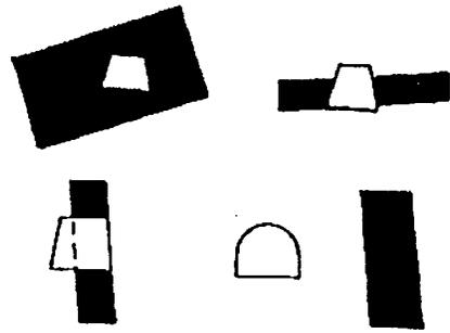
Рис. 3.10. Расположение штреков относительно залежи полезного ископаемого
