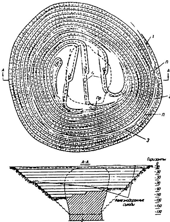
Рис. 5.10. Вскрытие спиральными съездами
