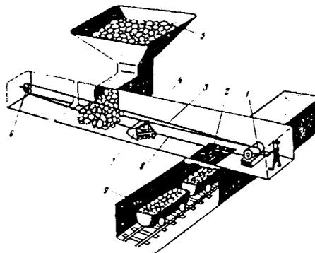
Рис. 6.50. Схема скреперной доставки и погрузки руды:
