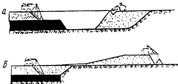
Рис. 5.22. Расположение внутренних (а) и внешних (б) отвалов
