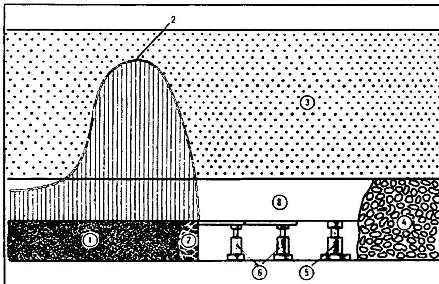
Рис. 6.24. Схема проявлений горного давления в лаве:
