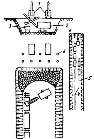
Рис. 5.6. Проходка траншеи сплошным забоем с нижней погрузкой породы в железнодорожные вагоны
