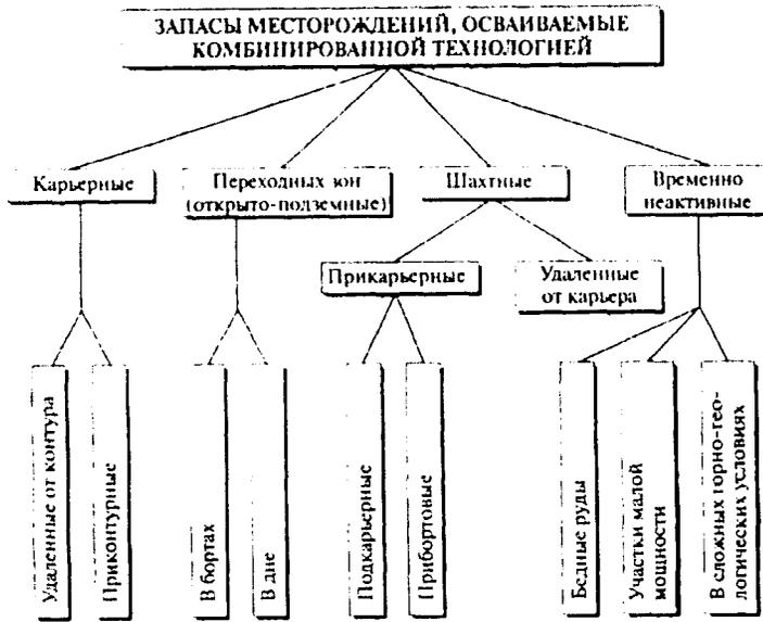
Рис. 7.2. Классификация запасов месторождений, осваиваемых комбинированной технологией
