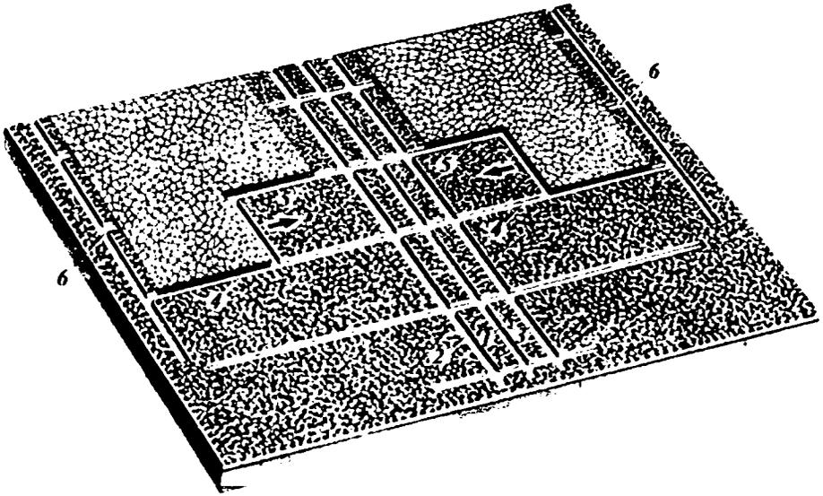
Рис. 6.27. Система разработки глинными столбами по простиранию:
