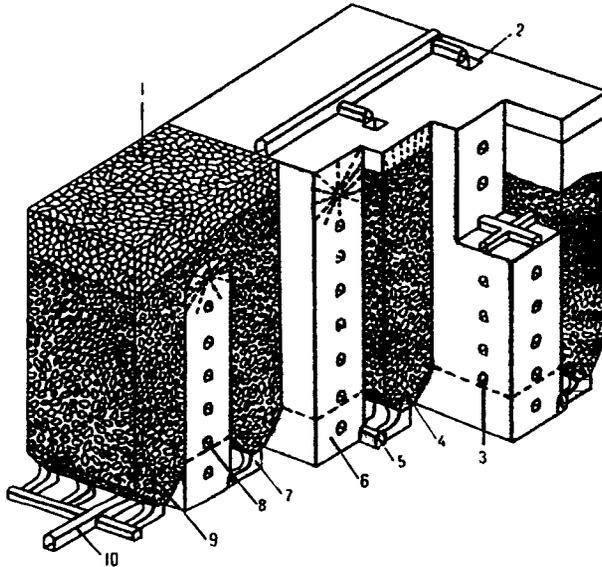
Рис. 6.64. Комбинированная система разработки с магазинированием руды в камерах и выемкой целиков подэтажным обрушением:
