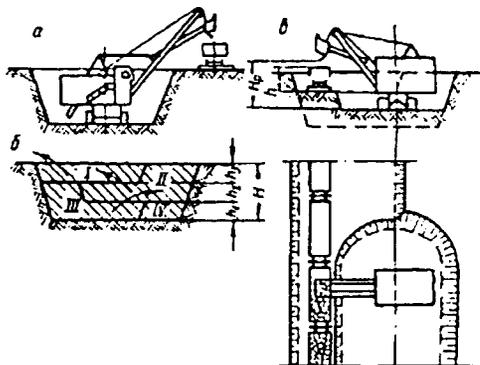
Рис. 5.7. Проходка траншеи сплошным забоем с верхней погрузкой породы
