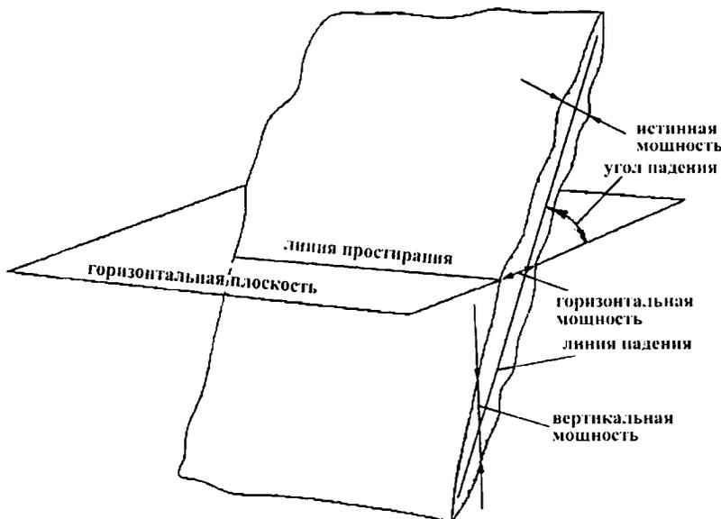
Рис. 3.6. Элементы залегания пласта
