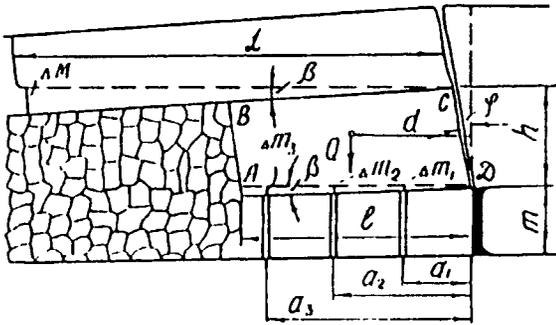
Рис. 6.25. Схема блочного обрушения пород кровли (по Г.Н. Кузнецову)
