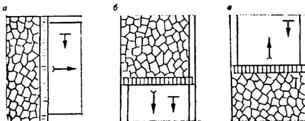
Рис. 6.20. Схемы подвигания очистных забоев:
