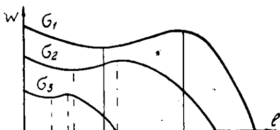
Рис. 5. Графическая зависимость, характеризующая устойчивое и неустойчивое состояние трещины (по Френкелю)
