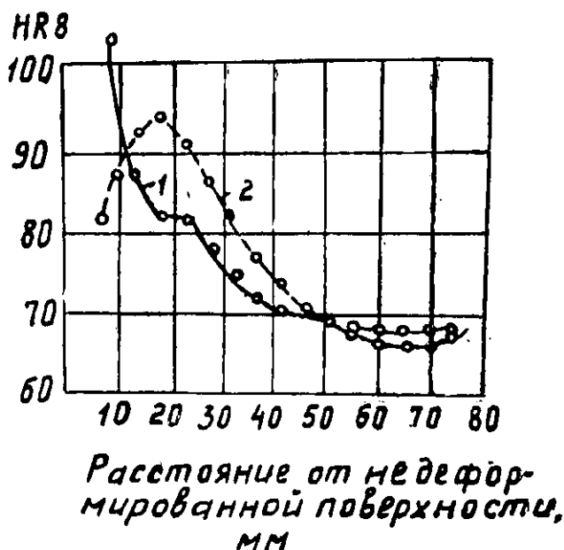
Рис. 1. Распределение твердости в деформированных стальных образцах: 1 — динамическая деформация, 2 — статическая деформация по [2]
