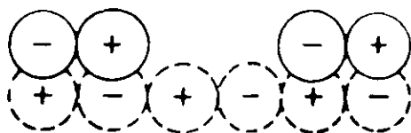
Рис. 8. Парка заряженных ступенек на конце лишней полуплоскости краевой дислокации с вектором Бюргера a/2 \langle 110 \rangle в решетке NaCl по [6]
