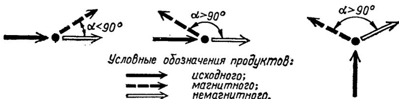
Рис. 158. Схемы подачи питания и удаления продуктов обогащения из рабочей зоны прямооточных (а), противоточных (б) и полупротивоточных сепараторов (в).
