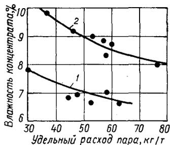
Рис. 213. Зависимость влажности магнетитового концентрата от удельного расхода пара при фильтровании:
