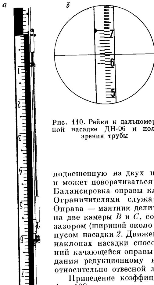
Рис. 110. Рейки к дальномерной насадке ДН-06 и поле зрения трубы
