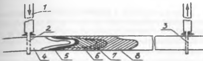
Рис. 10.6. Распространение фронта внутрипластового горения:
