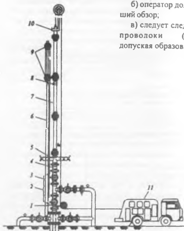
Рис. 4.11. Наземное оборудование газлифтной скважины:
