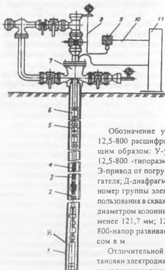
Рис. 6.12. Установка электродиафрагменного насоса (УЭДН):
