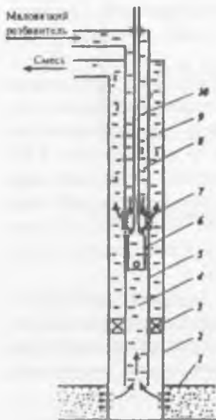
Рис. 8.23. Технологическая схема подъема высоковязкой нефти (ВНИИСПТнефти):
