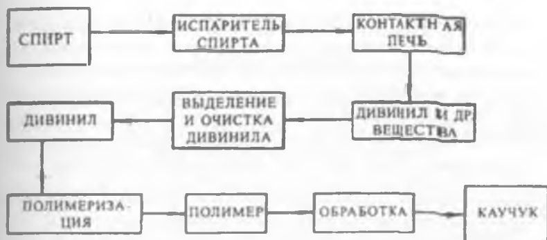
Рис. 12.36. Технологическая схема производства синтетического каучука.
