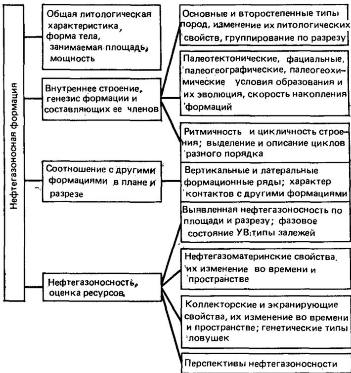
Рис. 1. Схема изучения нефтегазоносных формаций
