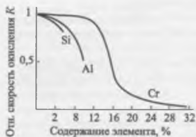
Рис. 3.15. Влияние легирующих элементов на относительную скорость газовой коррозии стали
