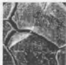
Рис. 5.3. Характер коррозионного разрушения стали. Сталь 09Х18Н14 с 0,75% Si после отпуска при 650 °С
