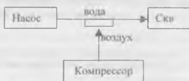
Пена является своеобразной азрированной жидкостью, её состав - это воздух, ПАВ и частицы выбуренной породы из скважины. Пласты с очень низкими давлениями и низкой проницаемостью разбуриваются с применением продувки забоя сжатым воздухом, газом (природным или отработанным от ДВС), при этом пласт не загрязняется.
