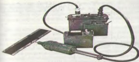
Рис. 8.3. Электроискровой дефектоскоп КРОНА-2И
