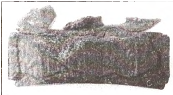
Рис. 2.7. Влияние среды на разрушение портландцементного камня: a — \text{H}_2\text{S} ; б — \text{H}_2\text{S} + конденсат
