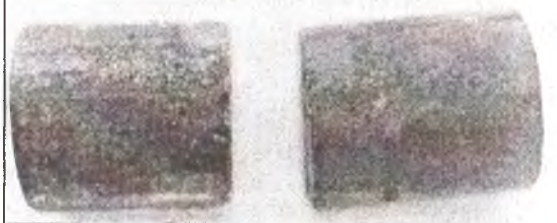
Рис. 6.10. Результаты испытания цемента в газе Оренбургского ГКМ: a — портландцемент ( B/C = 0,5 ; T = 80\text{ }^{\circ}\text{C} ; \tau = 2\text{ сут} ); б — портландцемент ( B/C = 0,5 ; T = 20\text{ }^{\circ}\text{C} ; \tau = 2\text{ сут} ); в — шлакоизвестково-кремнеземистое вяжущее ( B/C = 0,5 ; T = 1200\text{ }^{\circ}\text{C} ; \tau = 1\text{ сут} ); г — портландцементно-известково-золевое вяжущее ( B/C = 0,5 ; T = 80\text{ }^{\circ}\text{C} ; \tau = 2\text{ сут} )
