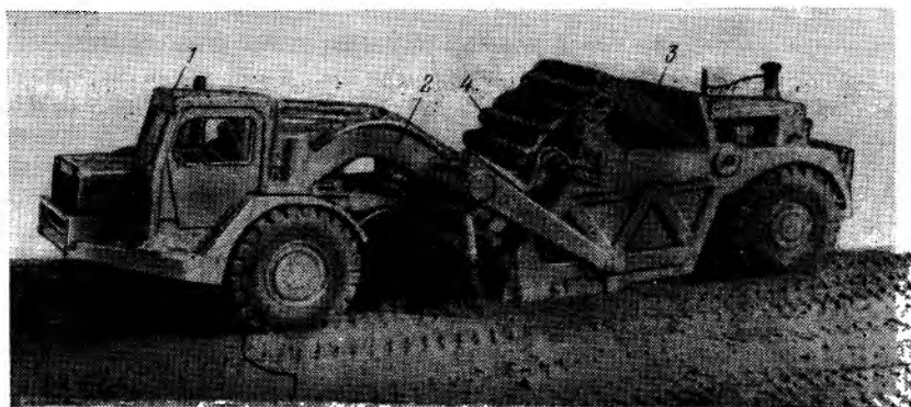
Рис. 12.15. Самоходный скрепер с элеваторной загрузкой:
