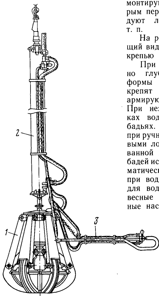
Рис. 16.9. Грейферный погрузчик КС-3:
