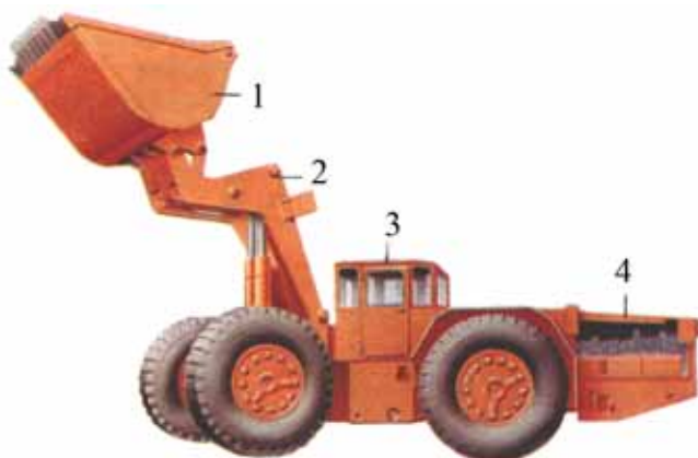
Рис. 5.18. Общий вид погрузочно-доставочной машины ПД-8: 1 – погрузочный орган; 2 – стрела; 3 – кабина управления; 4 – силовая установка
