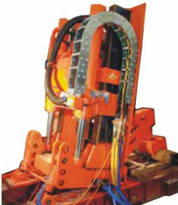
Рис. 4.17. Установка для бурения восстающих RHINO 2000DC
