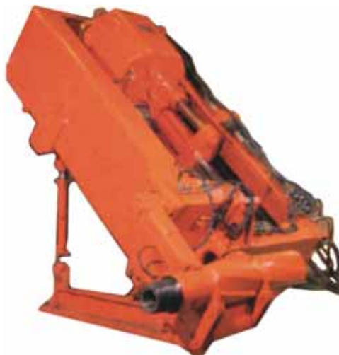
Рис. 4.15. Общий вид установки для бурения восстающих RHINO 400
