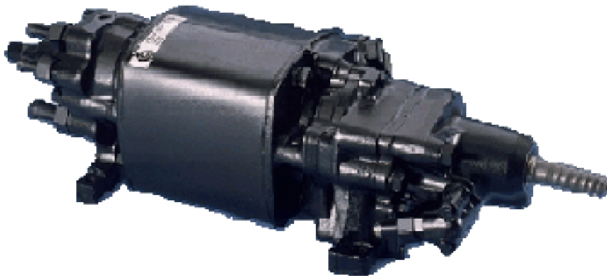
Рис. 1.39. Общий вид пневматического перфоратора СОР 900
