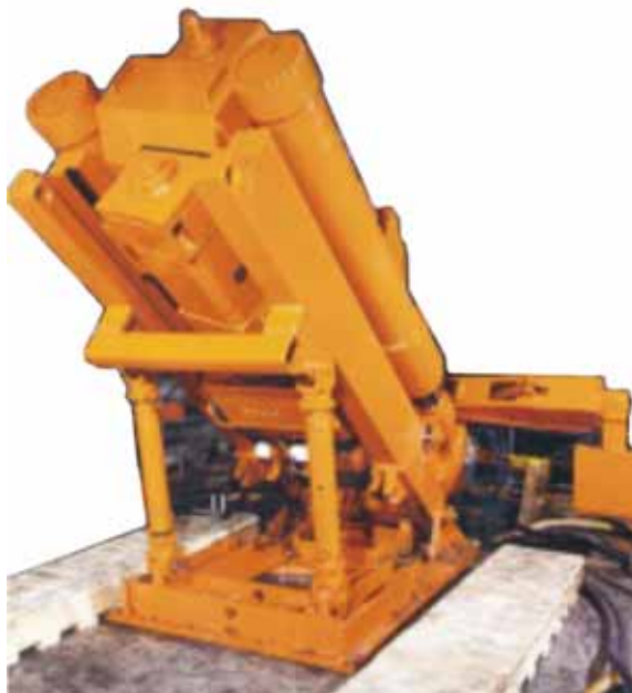
Рис. 4.16. Общий вид установки для бурения восстающих RHINO 1000
