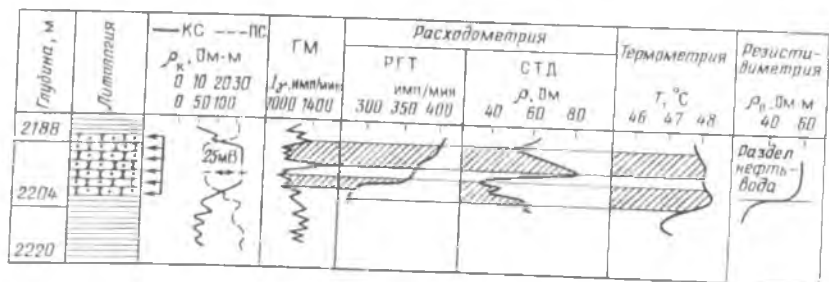
Рис. 58. Выделение работающих мощностей продуктивного пласта в скв. 267 Сосновского месторождения.
