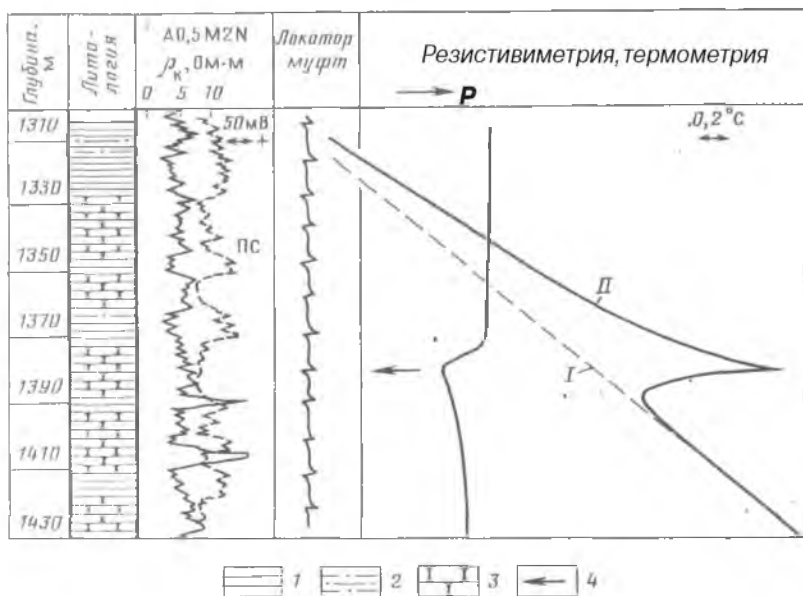
Рис. 81. Определение негерметичности колонны по данным термометрии и резистивиметрии в скв. 91 Западно-Сургутского месторождения.
