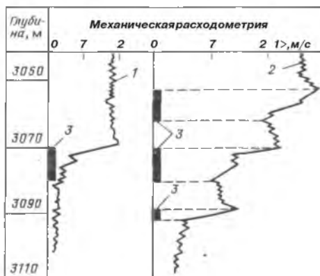
Рис. 65. Изменение работающей мощности пласта после солянокислотной обработки в скважине Вуктыльского газоконденсатного месторождения.
